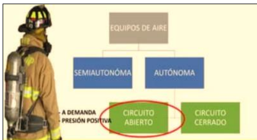
Ilustración 10. Circuito de los equipos ERA
