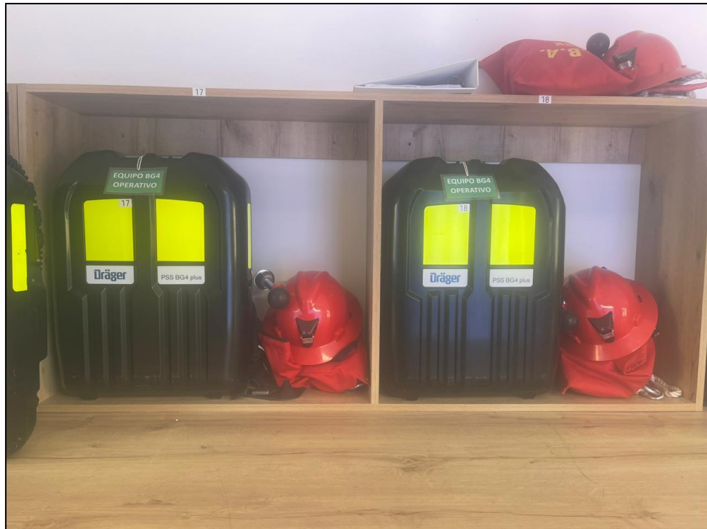
Ilustración 25. Equipos PSS BG4 PLUS - Proyecto Chaquicocha
