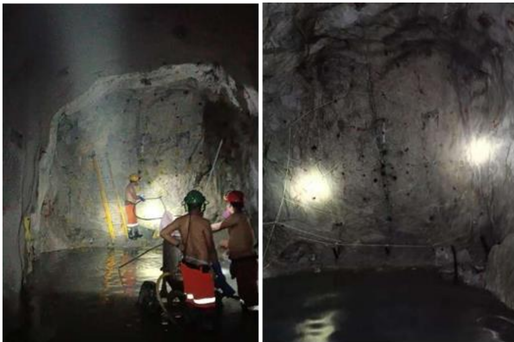
Figura 14. Se evidencia la perforación del arranque y la preparación de las cañas con ANFO a granel en tubería PVC \frac{3}{4} " en la GAL-400 NV.21 Sección Cuerpos.
