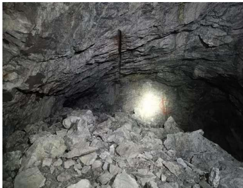
Figura 21. Se evidencia el resultado de la voladura en la GAL_253SW NV.20 Sección Cuerpos.
