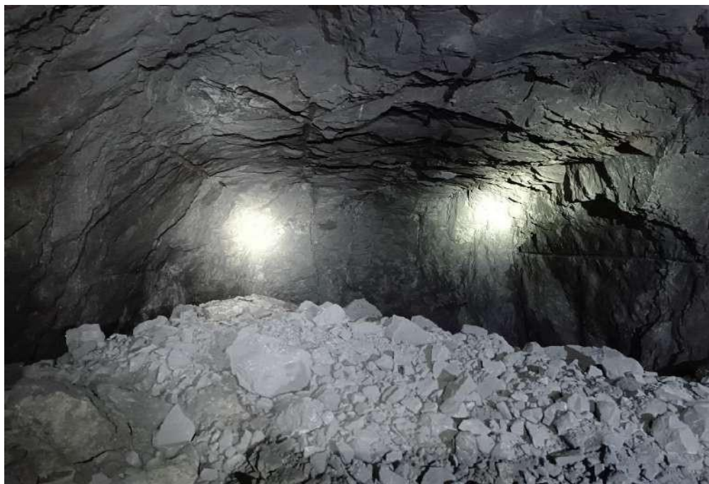
Figura 16. Se evidencia el resultado de la voladura en la GAL-400 NV.21 Sección Cuerpos.
