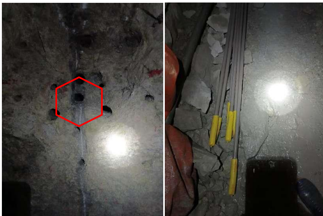
Figura 14. Se evidencia la perforación del arranque y la preparación de las cañas con ANFO a granel en tubería PVC \frac{3}{4} " en la GAL-400 NV.21 Sección Cuerpos.
