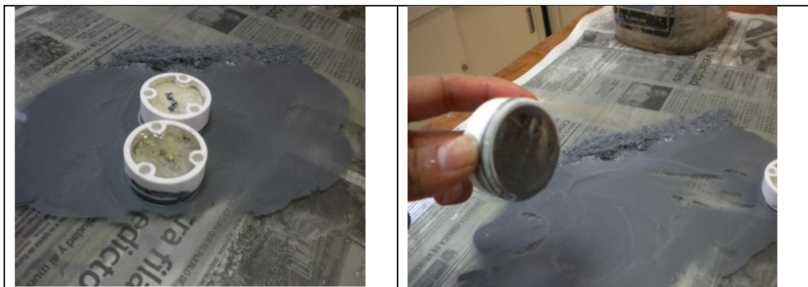
Figura 3. Ilustración de las etapas del lapeado
