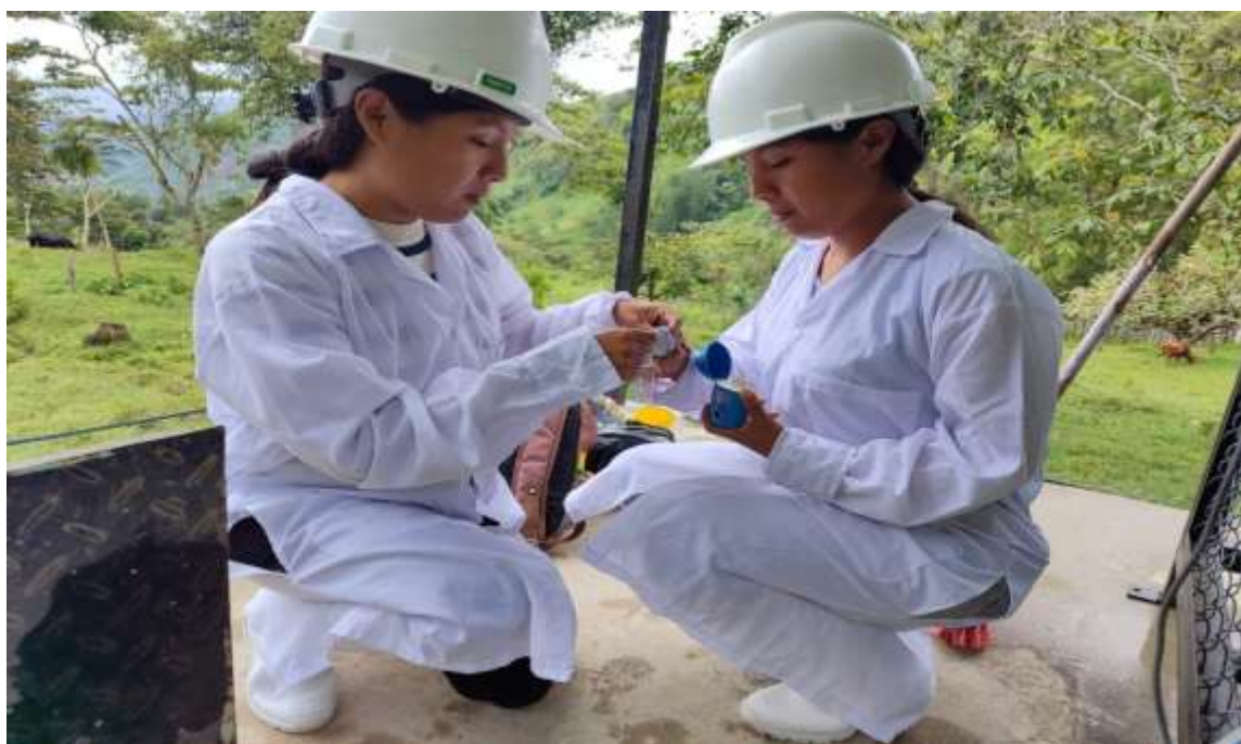
Fotografía 12. Medición de Cloro Residual.
