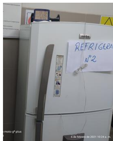
Foto 18. Camaras de refrigeracion usadas en la investigacion con los termohigrometros
