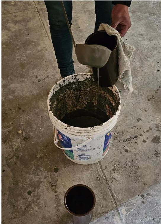
Se transporta la mezcla a las probetas cilíndricas para su moldeo con ayuda de un cucharón.
