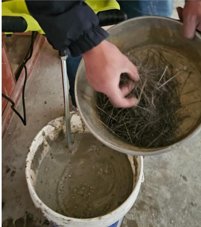
Se realiza los patrones experimentales aumentando fibras de acero al diseño de mezcla del concreto celular.
