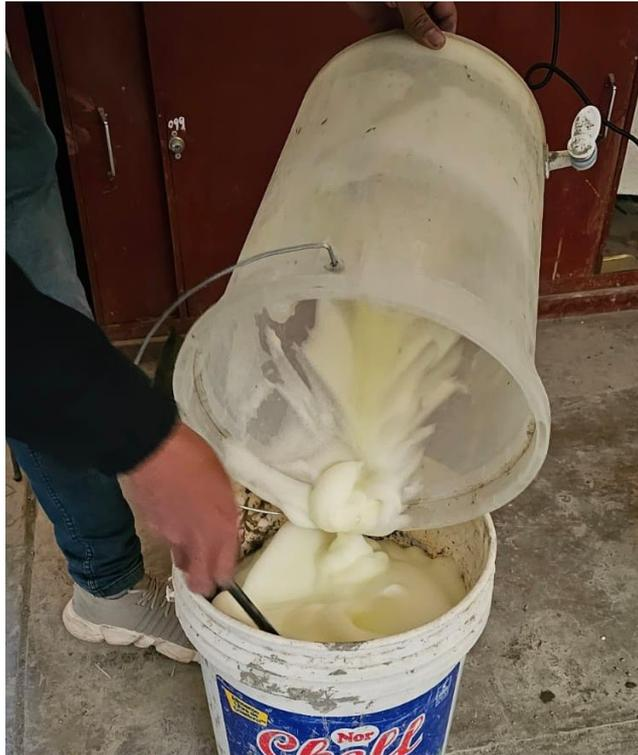
En la mezcladora se mezcló la proporción indicada en el diseño de mezcla y se combinó con la espuma generada
