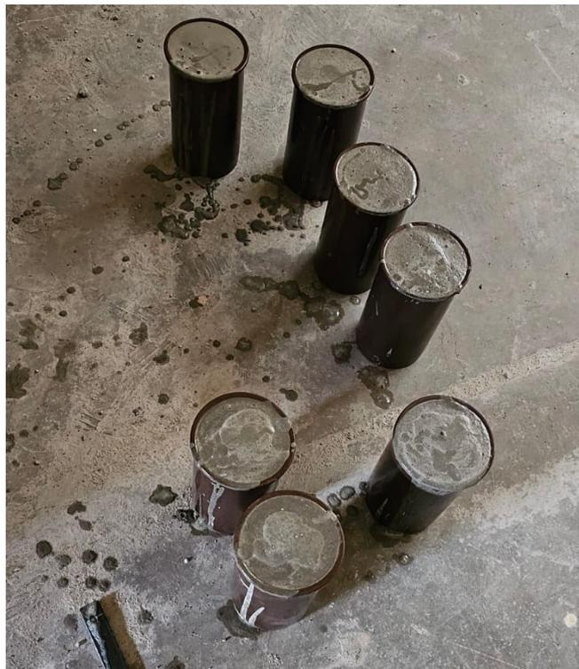
Se procede a dejar las probetas en una superficie para su respectivo secado.
