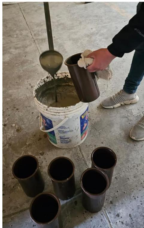
Luego se transporta la mezcla a las probetas cilíndricas para su moldeo con ayuda de un cucharón.
