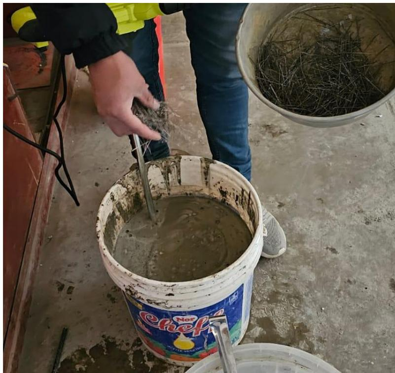
Se realiza los patrones experimentales aumentando fibras de acero al diseño de mezcla del concreto celular.
