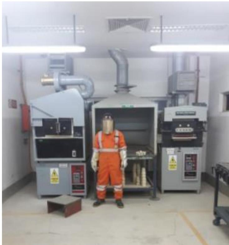
*Fotografía 7. Horno a gas para la fundición*
