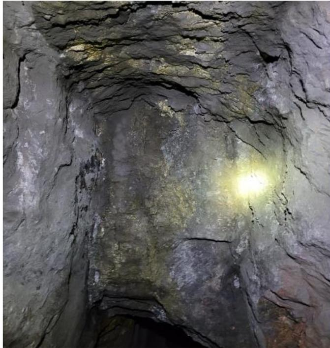
Nota. En la imagen se observa el macizo rocoso contiene calcosina, bornita y calcopirita en sus niveles superiores.
