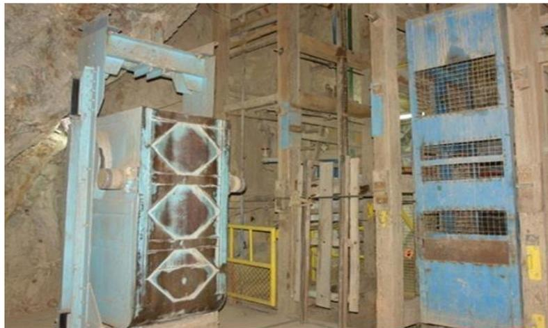
*Figura 5. Balde o skip y jaula para transporte de materiales*
