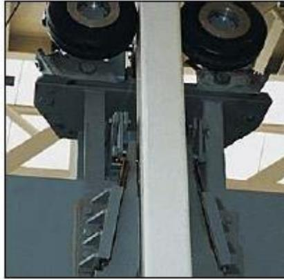
**Sistema E-FAS** (Elegido por MARSA) de sujeción Levelok para proporcionar una desaceleración controlada de un medio de transporte (jaula) con guías del pique de acero.
