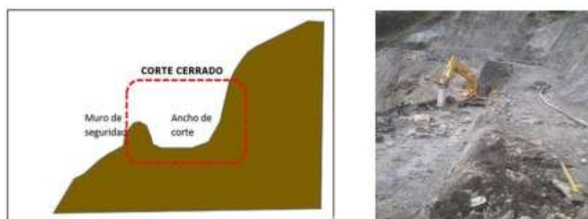
Figura 19. Corte de la roca para la entrada
