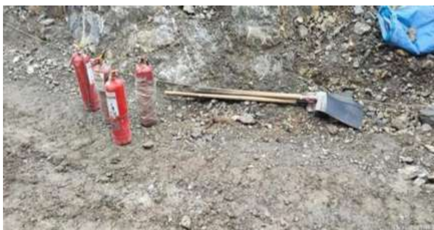
Figura 45. Bate fuego y Extintores
