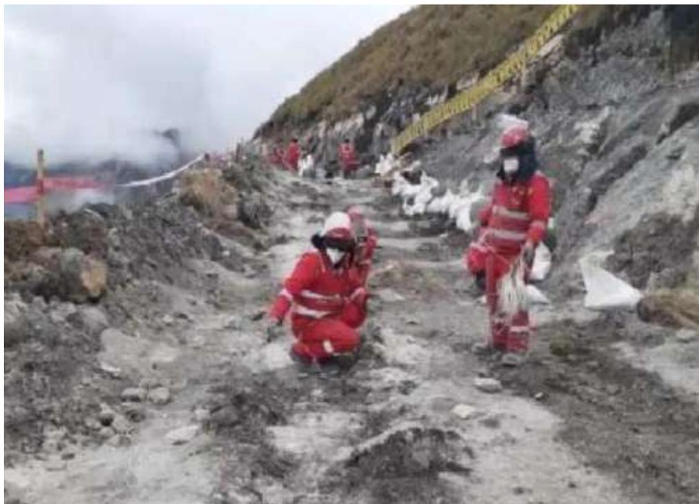
**Figura 61.** Recubrimiento de taladros con geomembrana, malla y sacos de stemming
