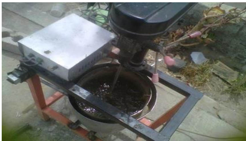
Figura 2. tratamiento de oxidación química del efluente liquido con cianuro.
