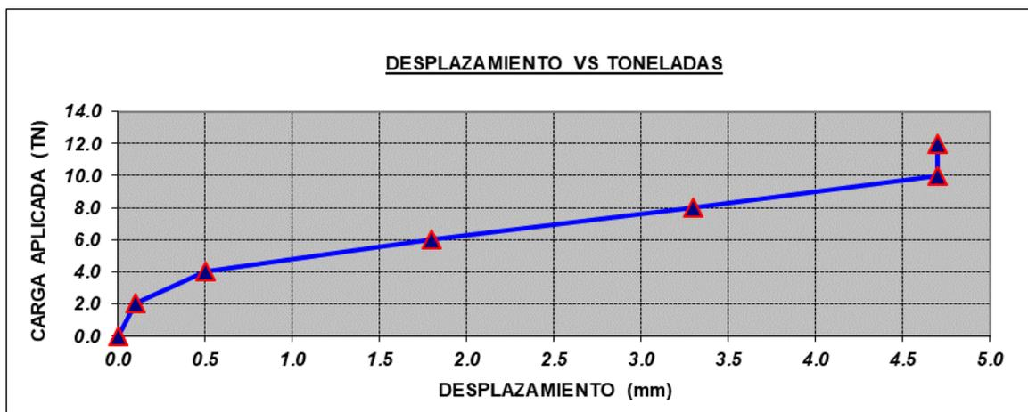
El Perno hydrabolt testado tiene una carga portante de 12 TN. Teniendo como Maximo desplazamiento 4,7 mm.
