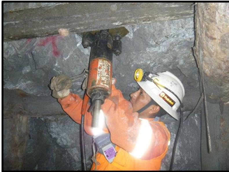
Foto N° 5.5: Instalado correcto de equipo Bolt Test
