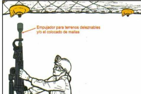
empujado de perno Hydrabolt
