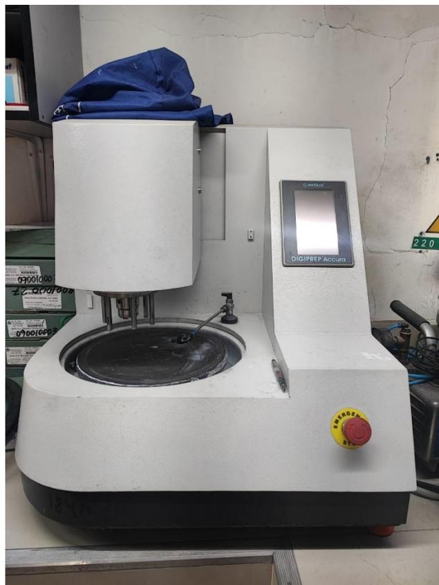
**Fotografía 14. Pulidora de probetas**
