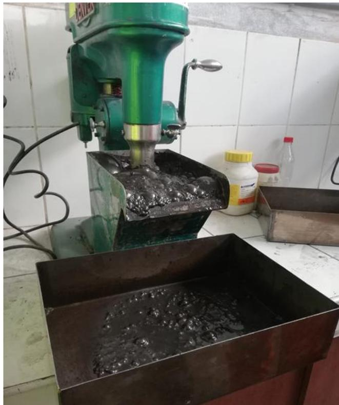
**Fotografía 8. Formación de espumas en la celda de flotación**
