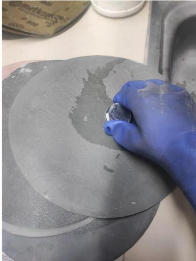
**Fotografía 13. Desbaste de probeta con lijas**
