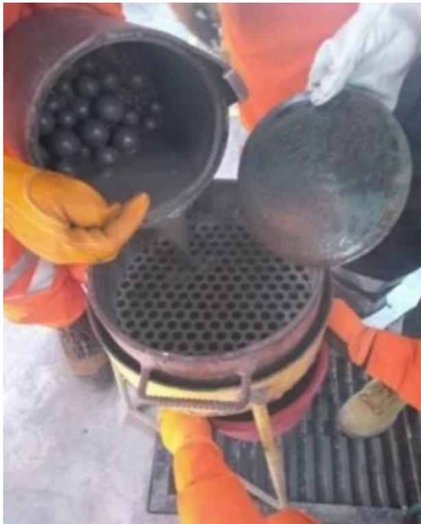
**Fotografía 4. Vaciado de pulpa molida**
