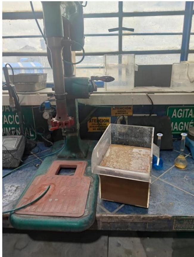
**Fotografía 6. Celda de Flotación**
