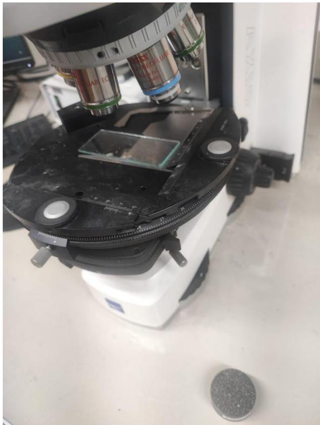
**Fotografía 12. Microscopio de minerales opacos**
