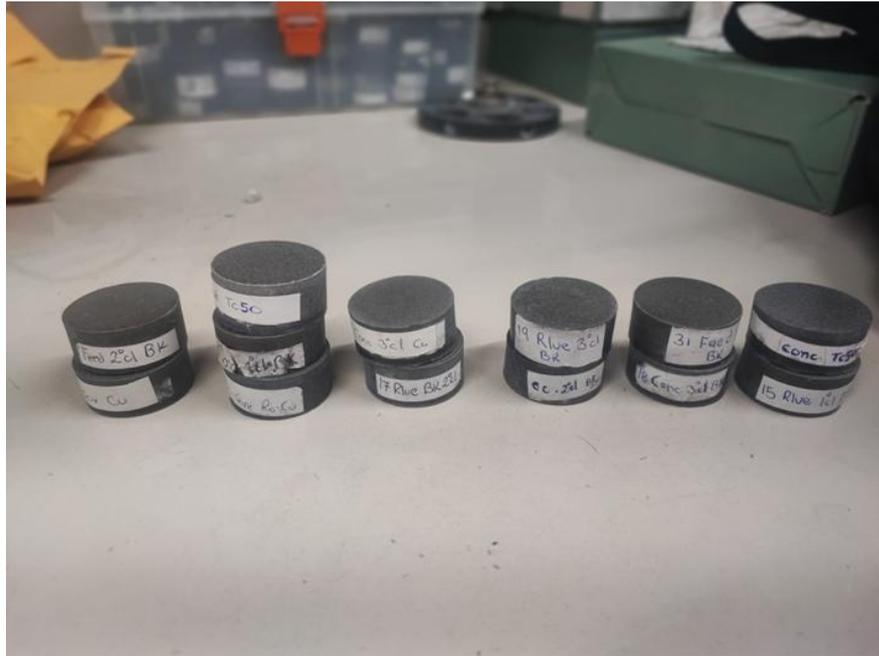
**Fotografía 15. Probetas preparadas para la visualización**
