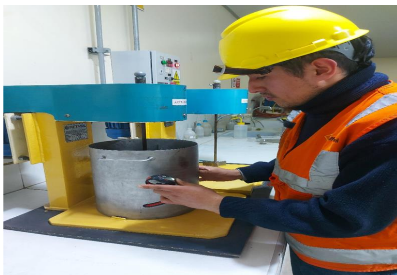
Figura 22 Ensayos experimentales de optimización de la recuperación de oro y plata
