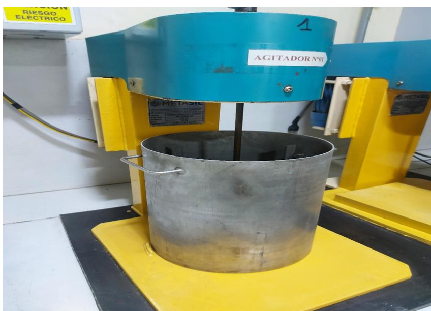
Figura 18 Tanque dinámico para los ensayos experimentales
