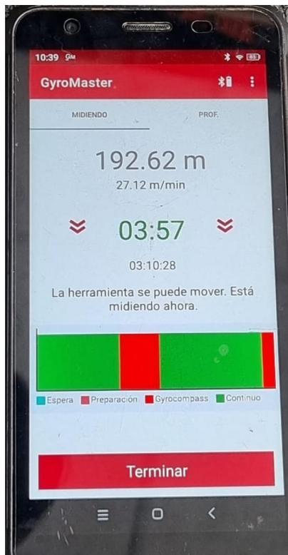
Anexo 3: Medición del sondaje DDHMR2345 en la plataforma de perforación.
