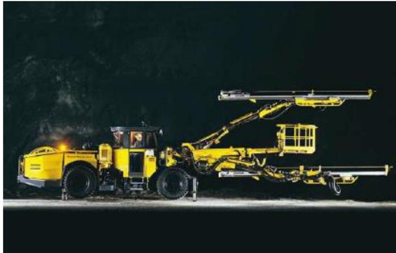
De acuerdo al trabajo que puedan hacer los equipos tenemos perforadoras para bancos, para avances de galerías y túneles ahí tenemos las perforadoras Boomer.
