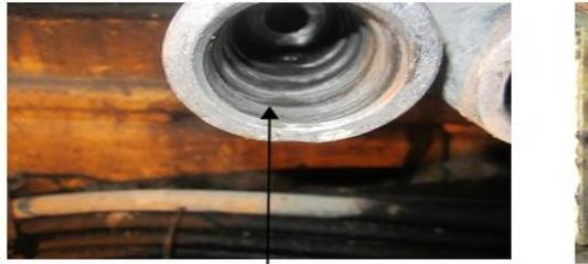
En la foto se observa que los hilos de la barra usada están gastados, estos hilos al ser mezclados con barras y shank nuevo aceleran el desgaste de estos componentes.
