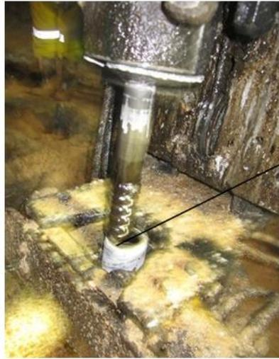
En la foto se observa, T1D#1 al momento de desembonado el shank choca con un hastial de couplin de la barra, ejerciendo fricción cte, y acelerando el desgaste de los hilos del Shank, eh hilos del couplin de la barra.
