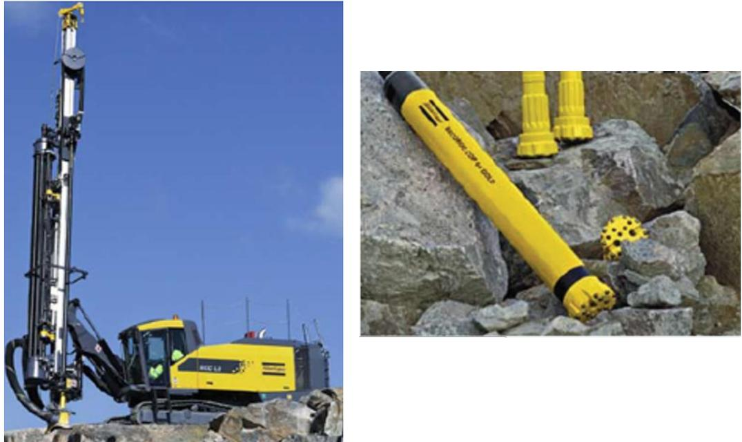
Tren de varillaje para un equipo mecanizado
