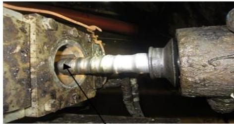
En la foto se observa el desgaste prematuro del shank debido a utilizar barras con hilos desgastados.
