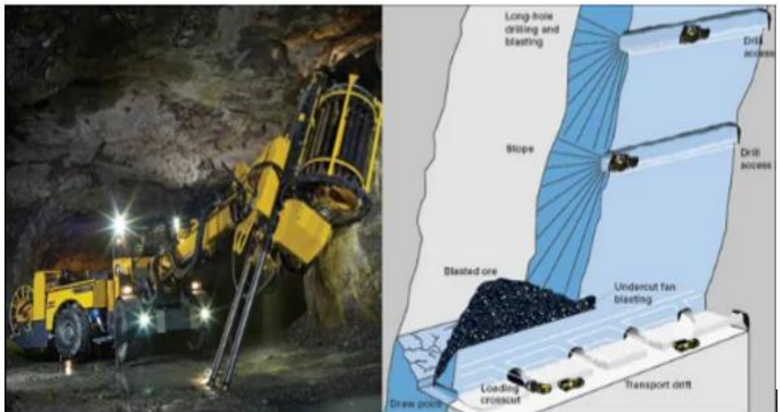
Figura 19 Gráfico del método Sublevel Stopping
