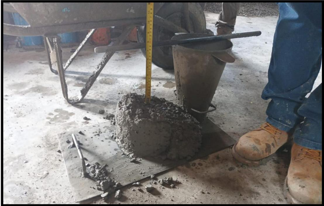
*Fotografía 11.- Medida del Slump del concreto.*
