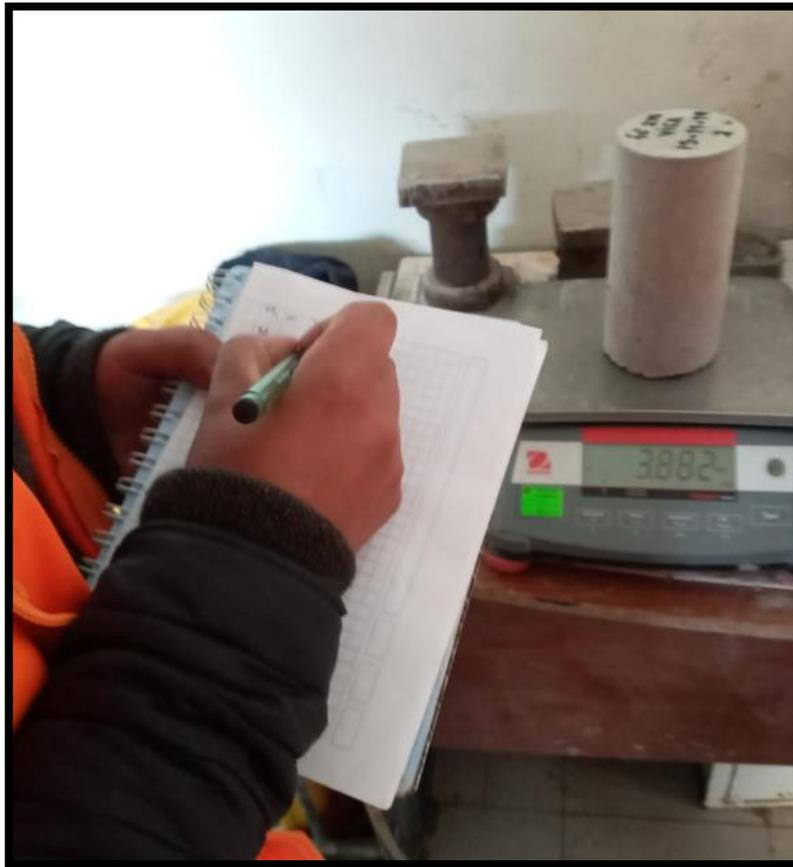
*Fotografía 15.- Pesaje de testigos cilíndricos.*
