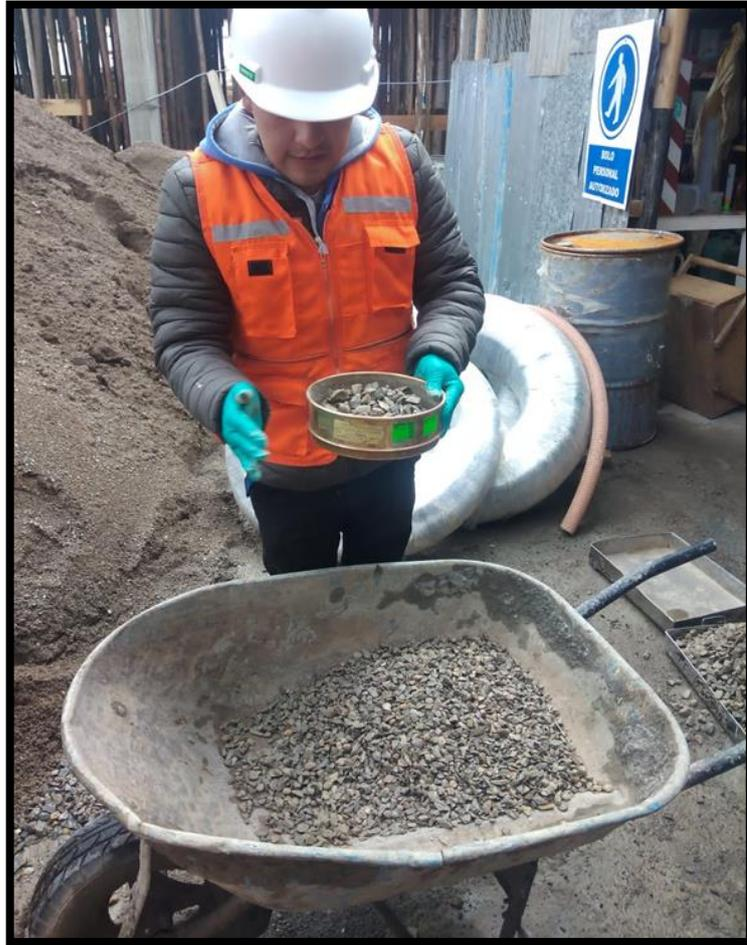
*Fotografía 03.- Tamizado de agregado grueso.*
