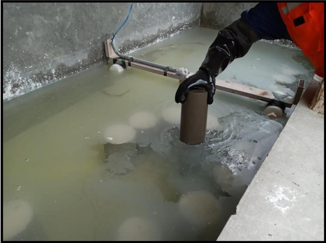
*Fotografía 13.- Curado de testigos cilíndricos para posterior rotura a 7, 14 y 28 días.*
