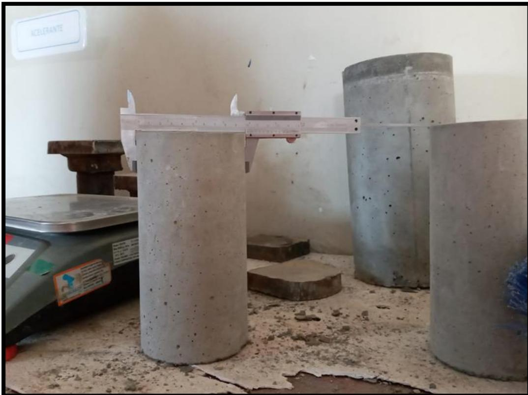
*Fotografía 14.- Medida de diámetro de testigos cilíndricos.*
