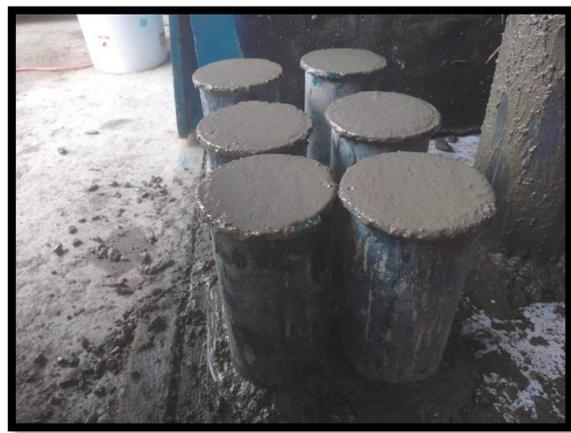
*Fotografía 12.- Muestreo de testigos cilíndricos para posterior evaluación de roturas a compresión.*
