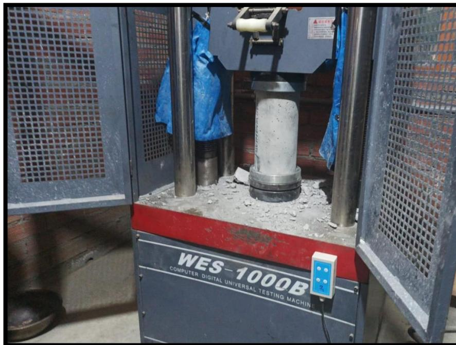
*Fotografía 16.- Colocado del testigo cilíndrico a la prensa para el ensayo a compresión.*
