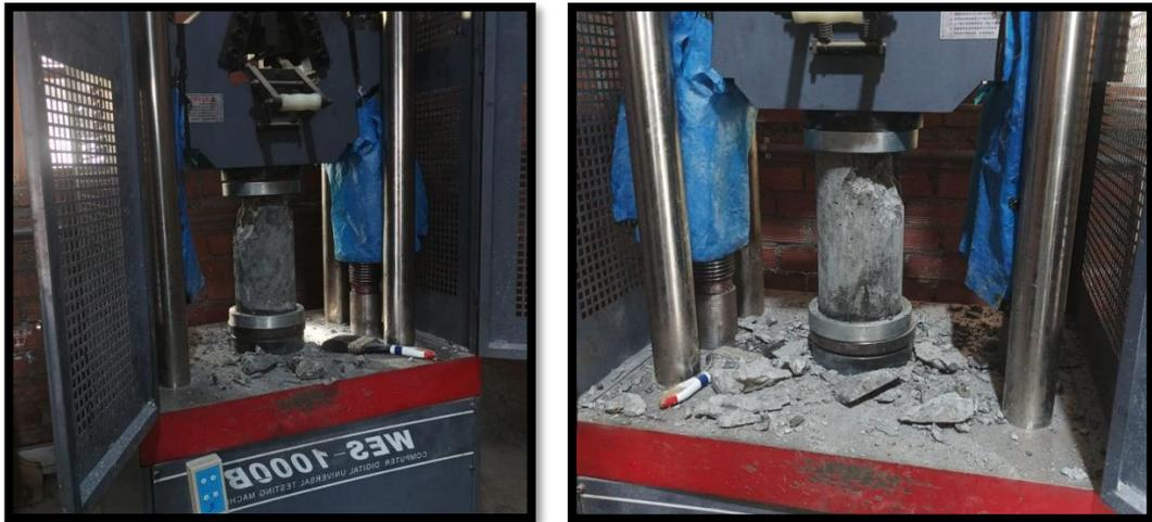
*Fotografía 17.- Verificación de los tipos de falla.*
