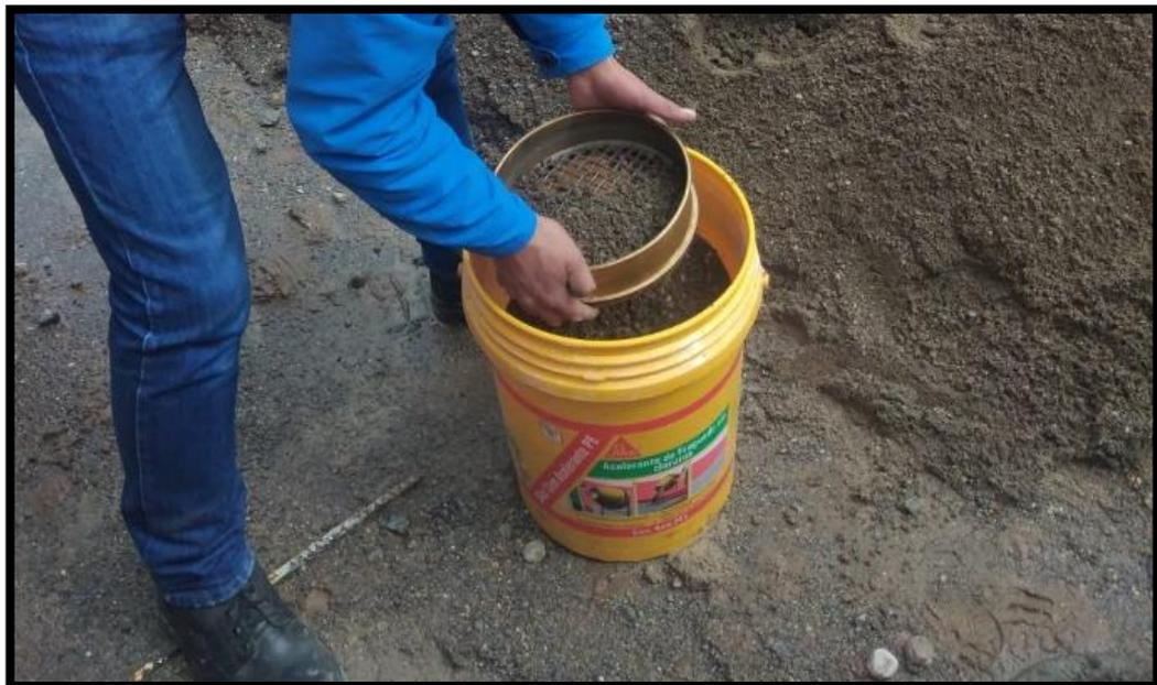
*Fotografía 04.- Tamizado de agregado fino.*
