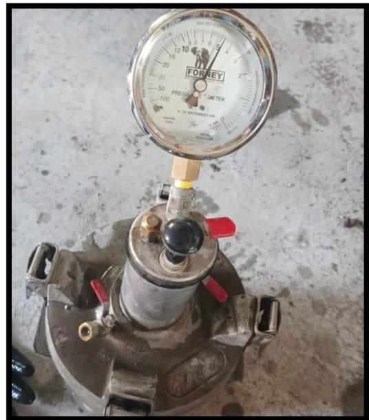
*Fotografía 10.- Medida de contenido de aire del concreto.*
