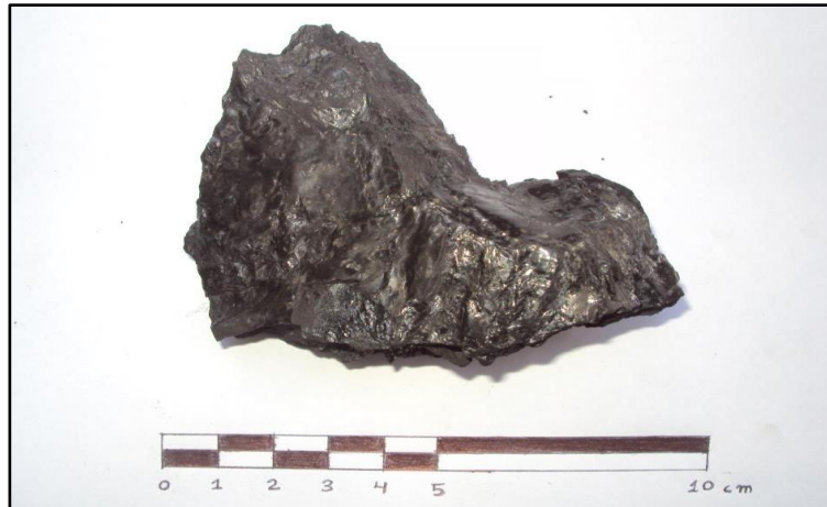
Fotografía 10. Roca de la caja piso del manto Lucia
