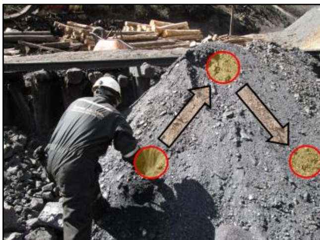
Fotografía 19. Muestreo en la cancha (En estrella).
