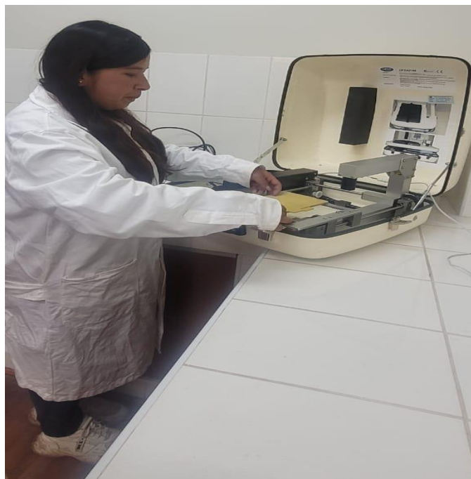
Foto 5.- Colocando la grátícula en el equipo OFDA
