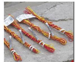
Electrónicos: carga eléctrica programable almacenada en el interior del detonador (condensador) con comando de detonación digital para iniciar la cuenta regresiva interna.
