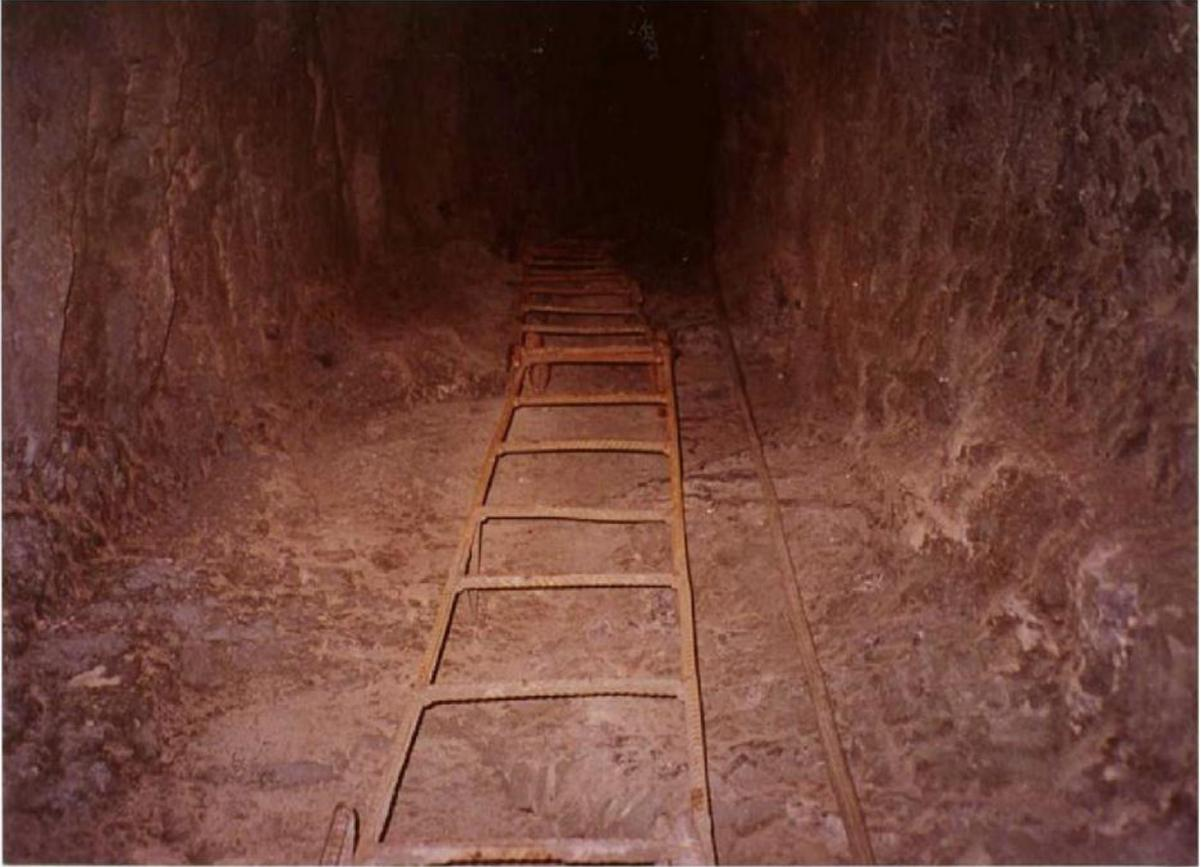
**Imagen N° 8: Escaleras Metálicas ancladas a una Chimenea**
