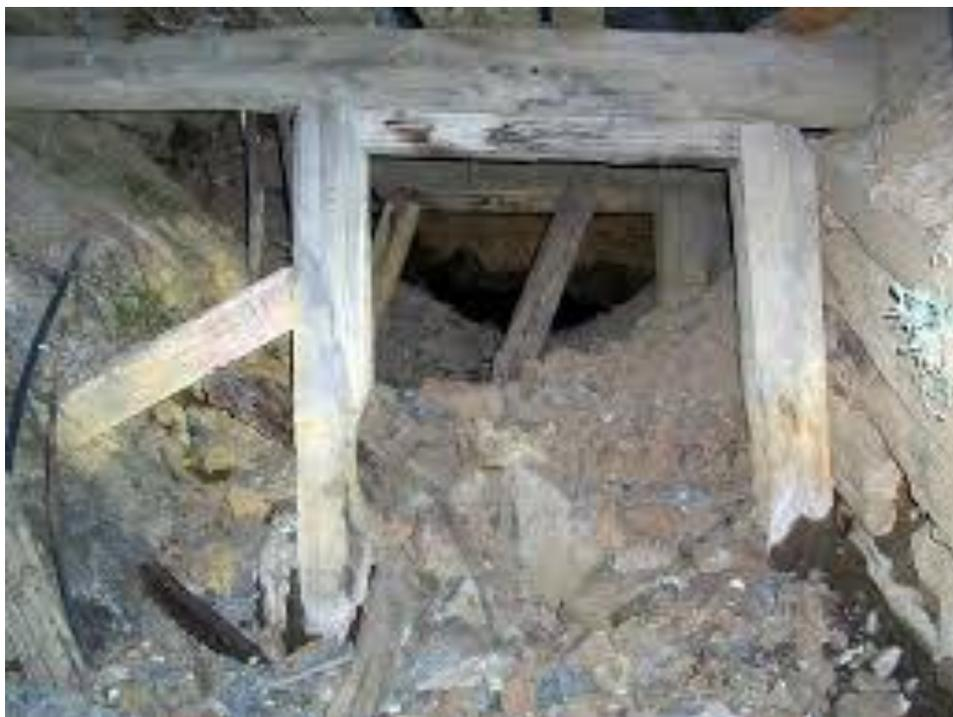
**Imagen N° 7: Chimenea deteriorada por el uso de madera con el sistema tradicional. Pérdida de material, tiempo y producción.**
