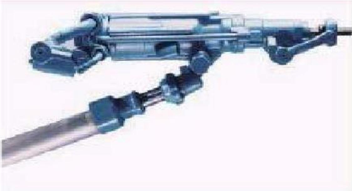
**Imagen N° 2: Perforadora Neumática Jackleg**
