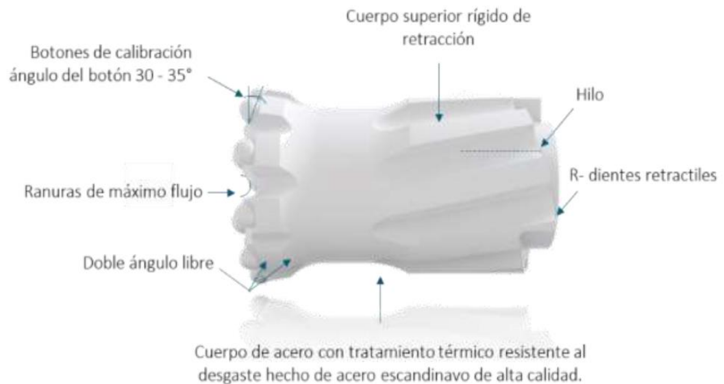
Figura 29 Partes de la retráctil GT60 de 5"- RG127DSR (Robit), vista lateral
