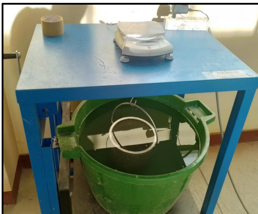
Ilustración 4. Se realiza el ensayo de peso específico y absorción del agregado grueso según las normas correspondientes a la NTP.
