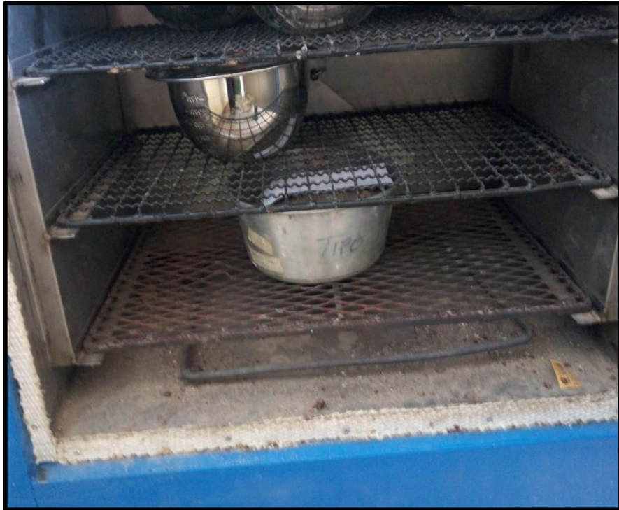
Ilustración 1. Secado de los agregados (finos y gruesos) para realizar los ensayos de granulometría, contenido de humedad, peso suelto y compactado, absorción y peso específico.
