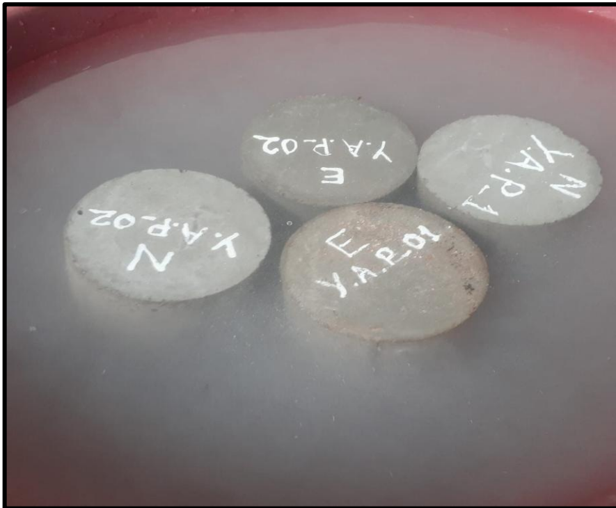
Ilustración 26. Después de sacar las probetas del molde se deja reposar por una hora y después se lleva a un recipiente con agua y cal para su respectivo curado durante 7, 14 y 28 días.
