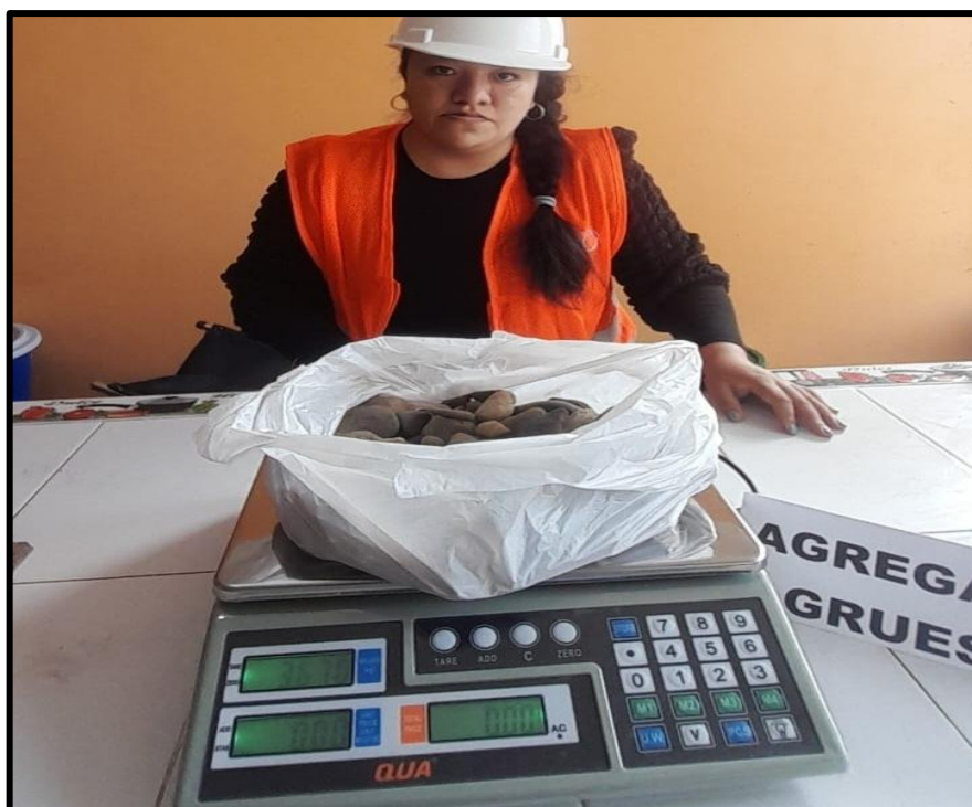
Ilustración 7. Se pesa la cantidad del agregado grueso según el diseño de mezcla para la elaboración del concreto tradicional y experimental.
