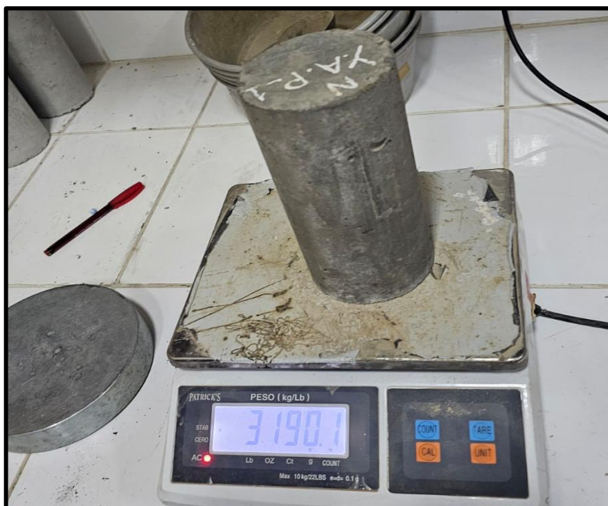
Ilustración 27. Pasado los días de curados, ya en el laboratorio se pesan las probetas para hallar el peso unitario y posteriormente realizar los ensayos de tracción y flexión.
