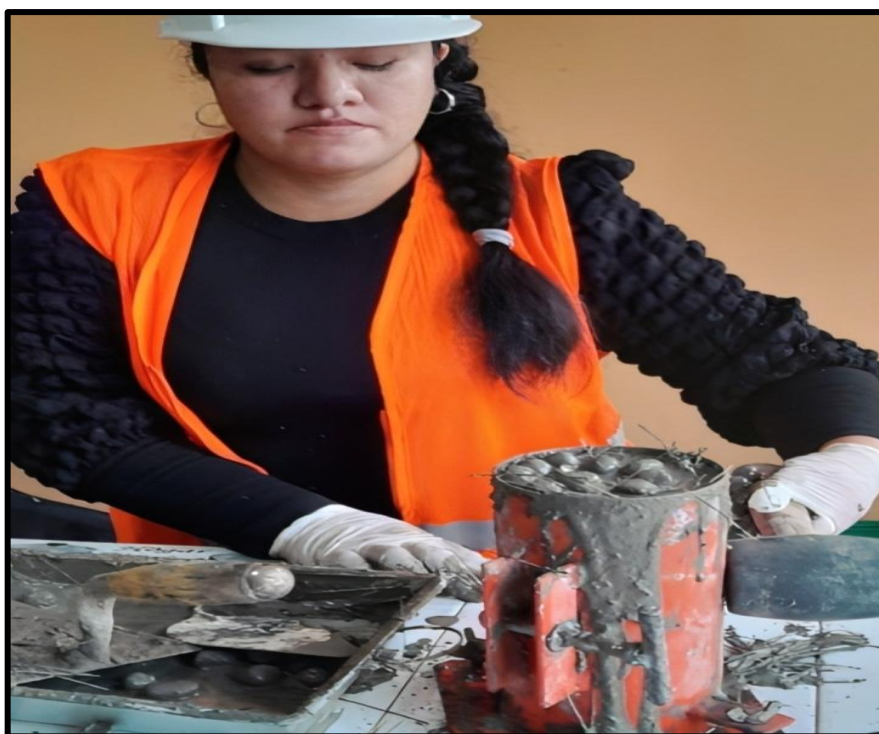
Ilustración 21. La compactación se complementa con 10 golpes con martillo de goma al alrededor de la probeta
