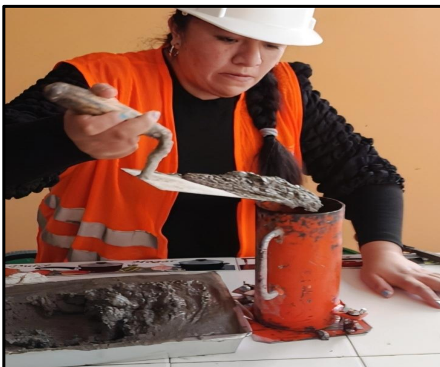
Ilustración 14. Se empieza a trasladar la mezcla a las probetas de 10 cm de diámetro y 20 cm de altura.
