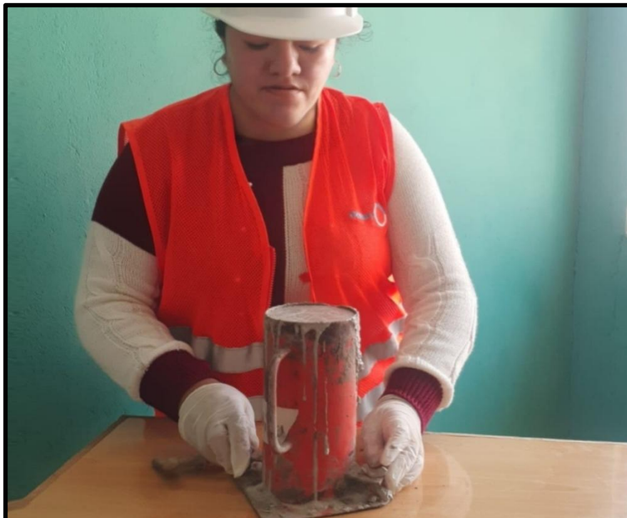
Ilustración 22. Después de haber secado el concreto tradicional por 24 horas se retira del molde cuidadosamente.
