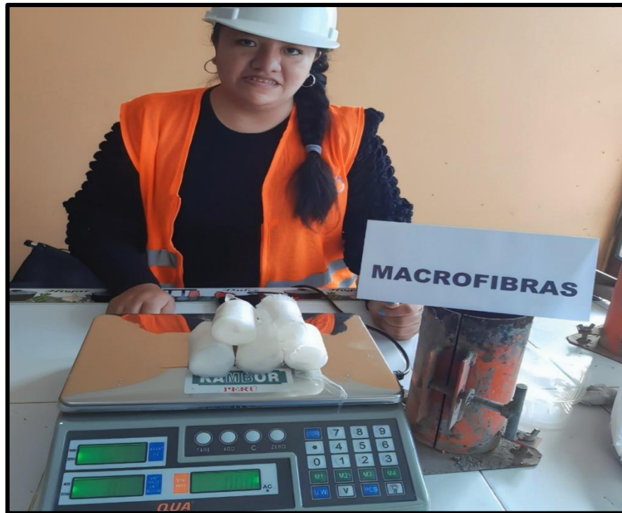
Ilustración 11. Se pesa la cantidad de las macrofibras ( 2.5 \text{ kg/m}^3 , 5.0 \text{ kg/m}^3 y 7.5 \text{ kg/m}^3 ) según el diseño de mezcla para la elaboración del concreto experimental.
