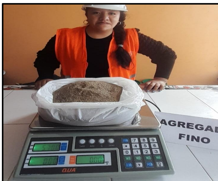
Ilustración 8. Se pesa la cantidad del agregado fino según el diseño de mezcla para la elaboración del concreto tradicional y experimental.
