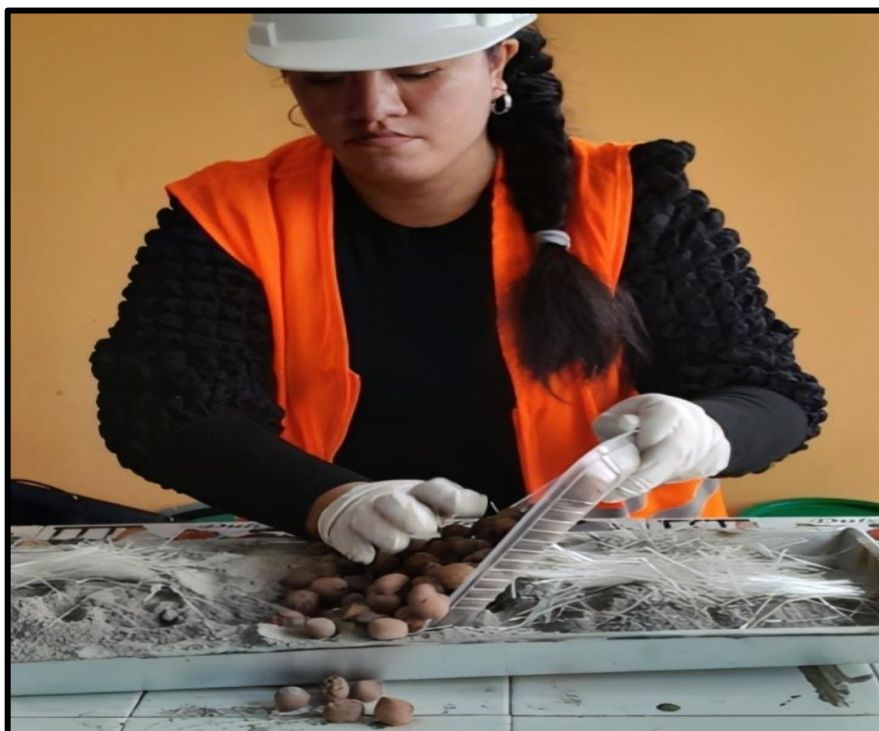
Ilustración 18. Después echamos la arcilla expandida en la mezcla, tuvimos en cuenta que la arcilla expandida fue remojada por 24 horas, la cual sirve para que no absorbe el agua del mezclado.
