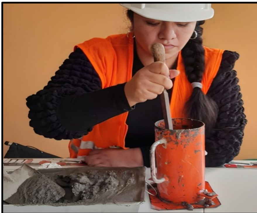
Ilustración 15. Se realiza la compactación correspondiente a las normas vigentes, la cual indica realizar 25 golpes en tres capas.
