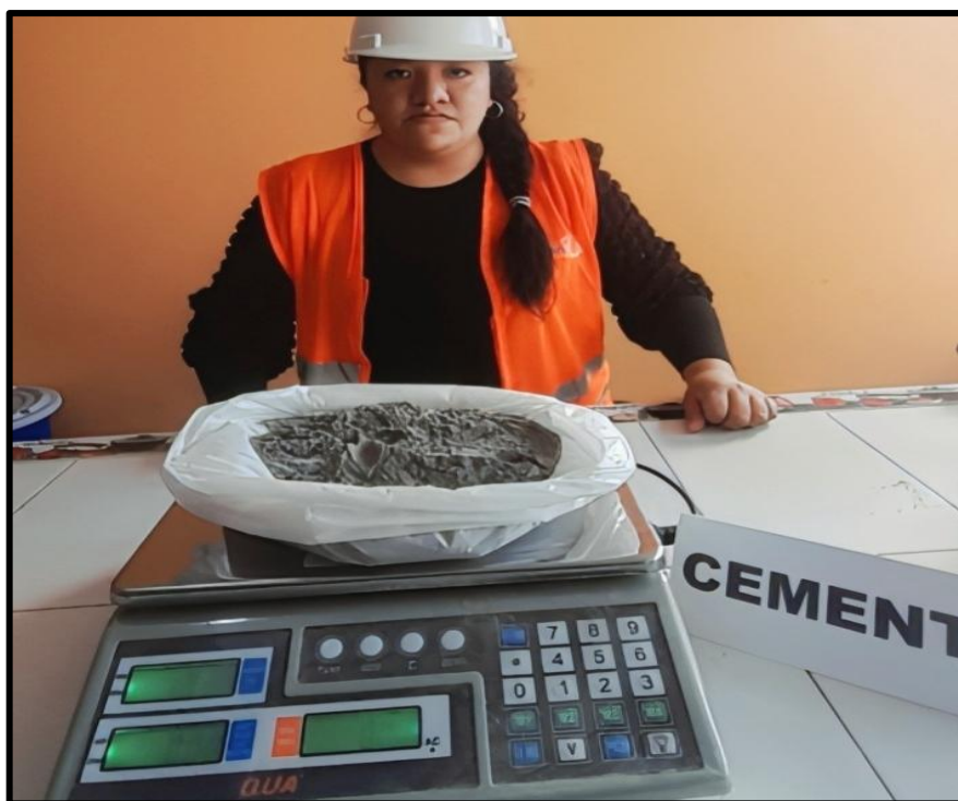
Ilustración 9. Se pesa la cantidad del cemento según el diseño de mezcla para la elaboración del concreto tradicional y experimental.
