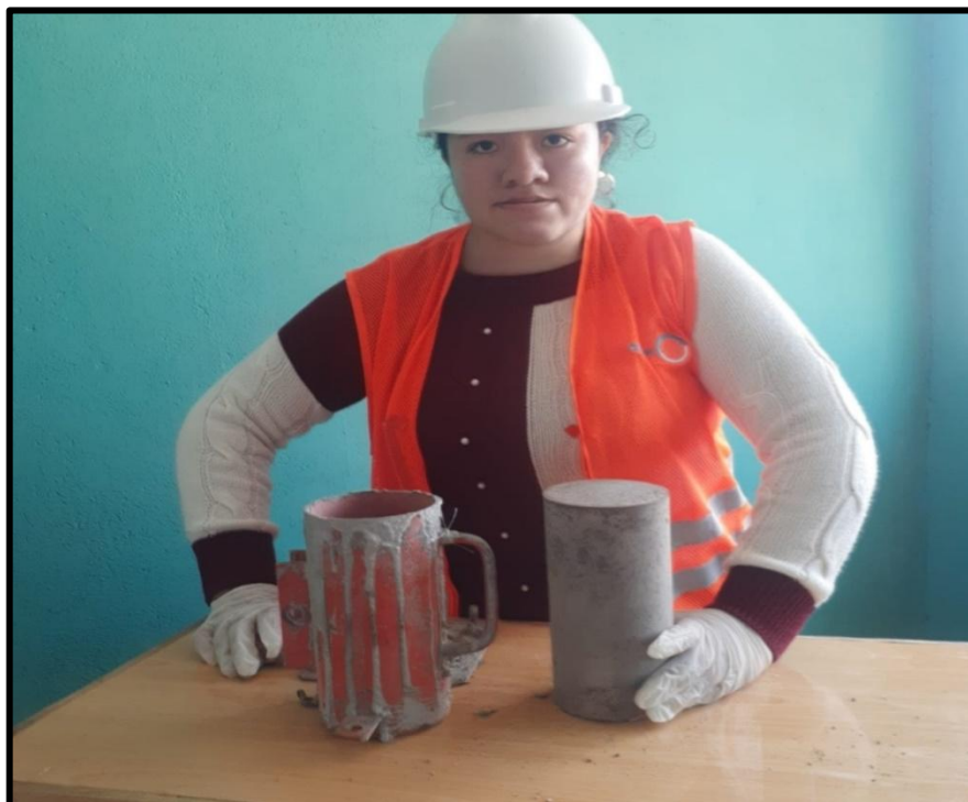
Ilustración 24. De igual manera después de haber secado el concreto experimental por 24 horas se retira del molde cuidadosamente.
