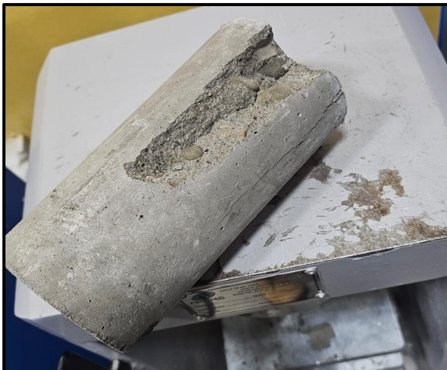
Ilustración 30. Se observa que la probeta de concreto tradicional tiene una falla de corte en "y".
