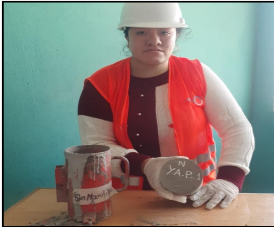
Ilustración 23. Se realiza a poner el código en cada probeta para no tener ningún inconveniente al realizar el ensayo de tracción y flexión.
