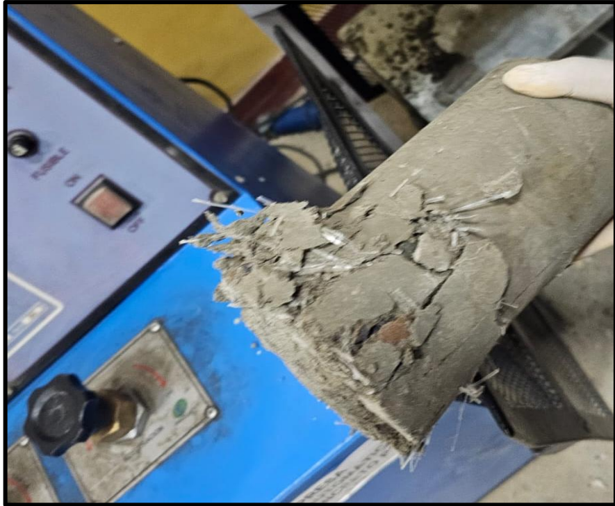
Ilustración 31. Con las probetas de concreto experimental observamos que no tiene mucha resistencia a la tracción ya que tiene una falla de corte y hundimiento.
