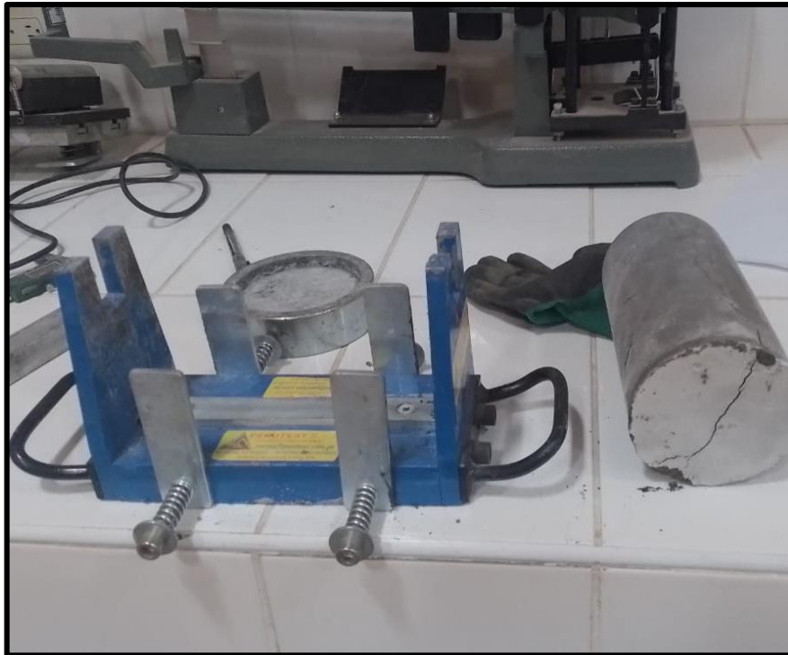
Ilustración 29. Se realiza el ensayo de tracción de cada probeta de concreto tradicional y experimental, observando el tipo de falla obtenida.
