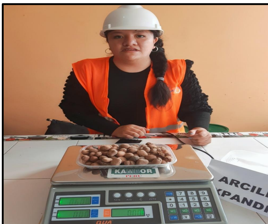
Ilustración 10. Se pesa la cantidad de la arcilla expandida (20%, 30% y 40%) según el diseño de mezcla para la elaboración del concreto experimental.
