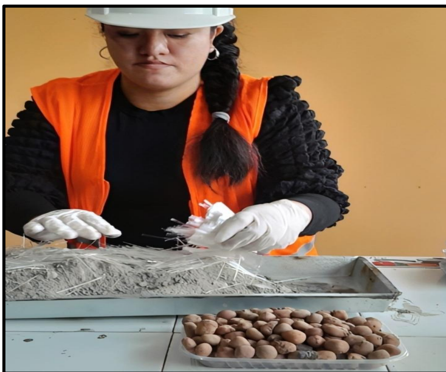
Ilustración 17. Se empieza a incorporar las macrofibras, esparciendo poco a poco por los agregados.
