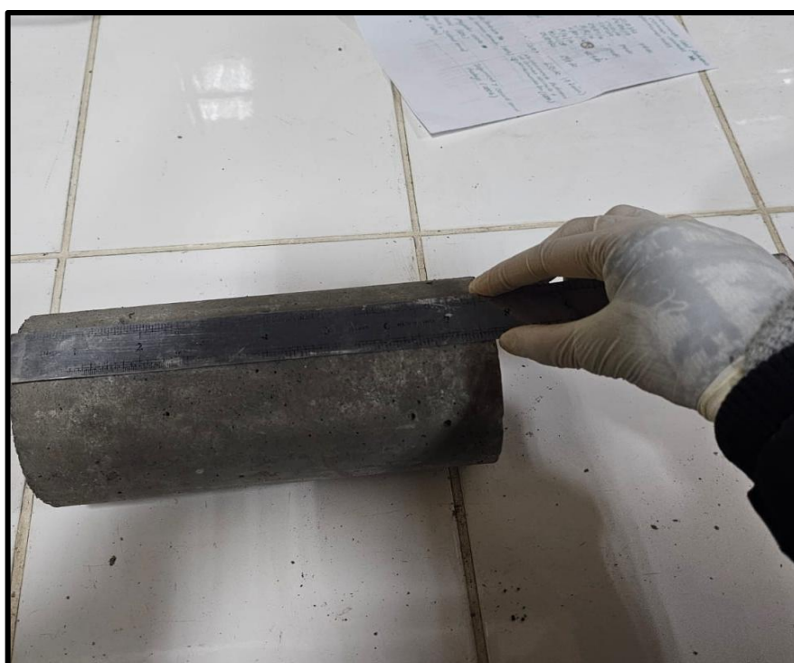
Ilustración 28. Se realiza la medición de la altura y el diámetro de cada probeta y posteriormente realizar el ensayo de tracción y flexión.
