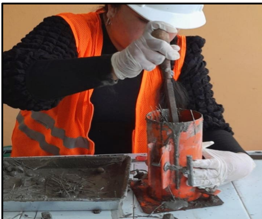
Ilustración 20. También se realiza la compactación correspondiente a las normas vigentes, la cual indica realizar 25 golpes en tres capas.
