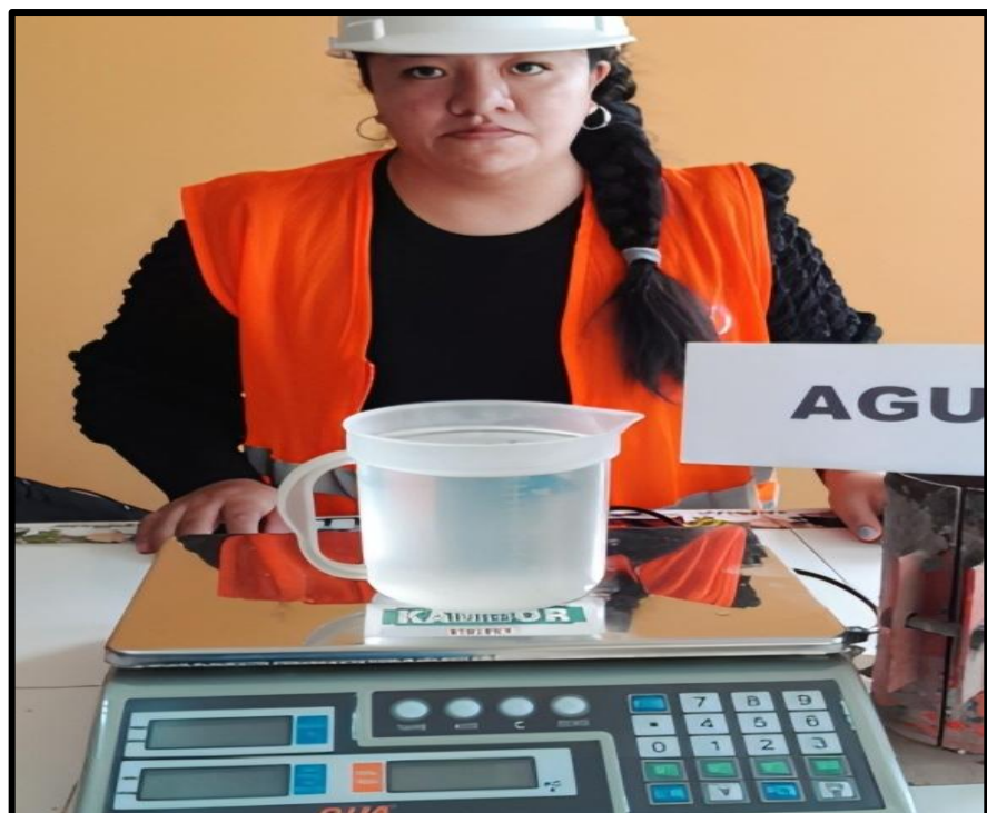
Ilustración 12. Se pesa la cantidad del agua según el diseño de mezcla para la elaboración del concreto tradicional y experimental.
