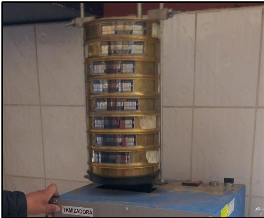
Ilustración 2. Se realiza el ensayo de granulometría de cada agregado (fino y grueso) usando la tamizadora.
