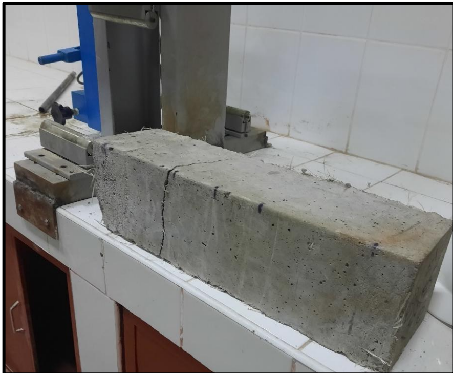
Ilustración 32. Observamos el resultado de la falla de la probeta prismática del concreto experimental, al realizar el ensayo de resistencia a flexión.
