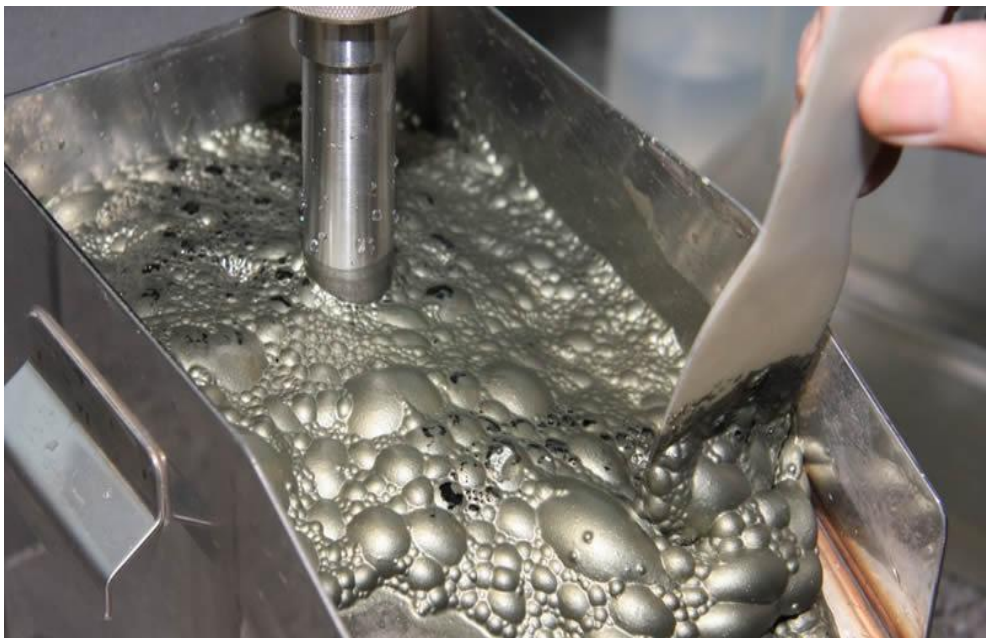
Fotografía 2. Evacuación de espumas bulk
