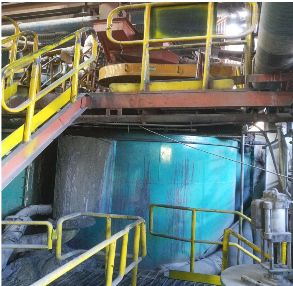
Fotografía 6. Celda OK 50 Bulk
