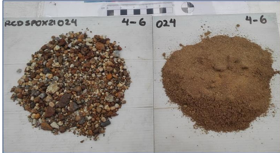
Figura 28: RLL_BXHTB Relleno brecha hidrotermal con toba
