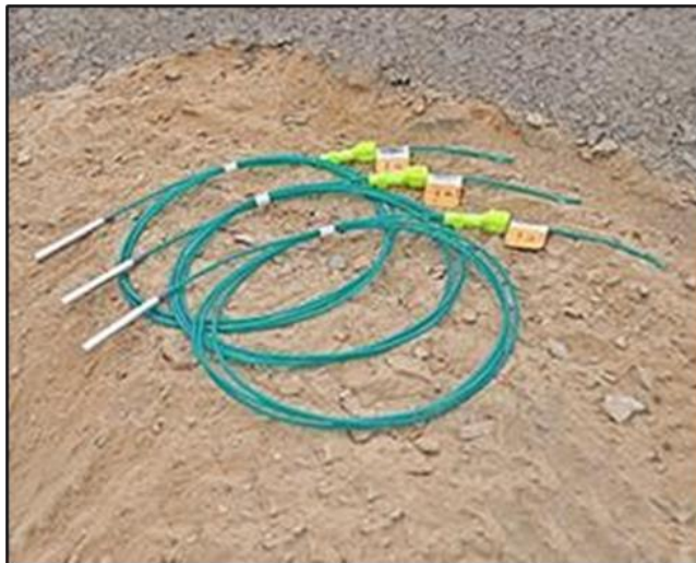
Ilustración 11: Minivel, sistema de iniciación no eléctrica
