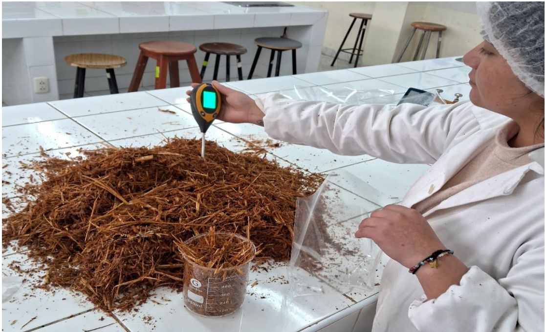
Ilustración 9. Medición de humedad, temperatura y pH en los sustratos después de la mezcla.
