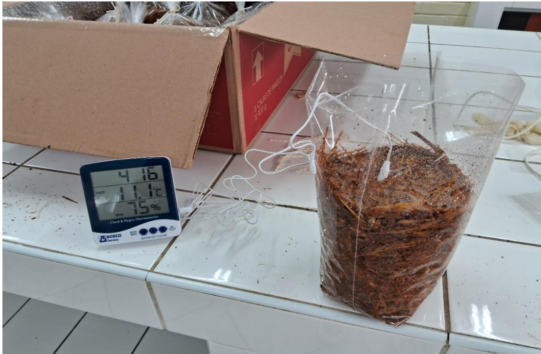
Ilustración 14. Medición de humedad, temperatura y pH en los pasteles antes de sellarlos.
