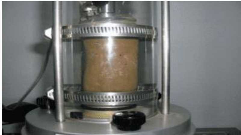
Foto N° 02. Ensayo de Compresión Triaxial (foto extraída de Prodyogi).
