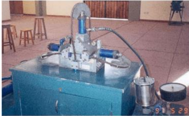
Foto N° 05. Maquina donde se fija los parámetros de resistencia al corte.
