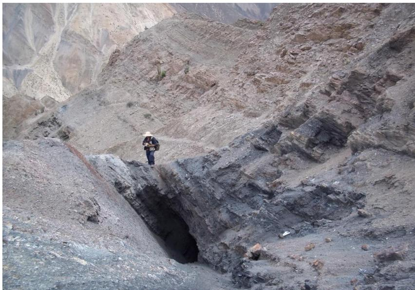
**Foto 2. Chimenea de ventilación en zona de Vizcaya, muestra de trabajos realizados hasta superficie a lo largo del manto de Carbón Carito 1.**
