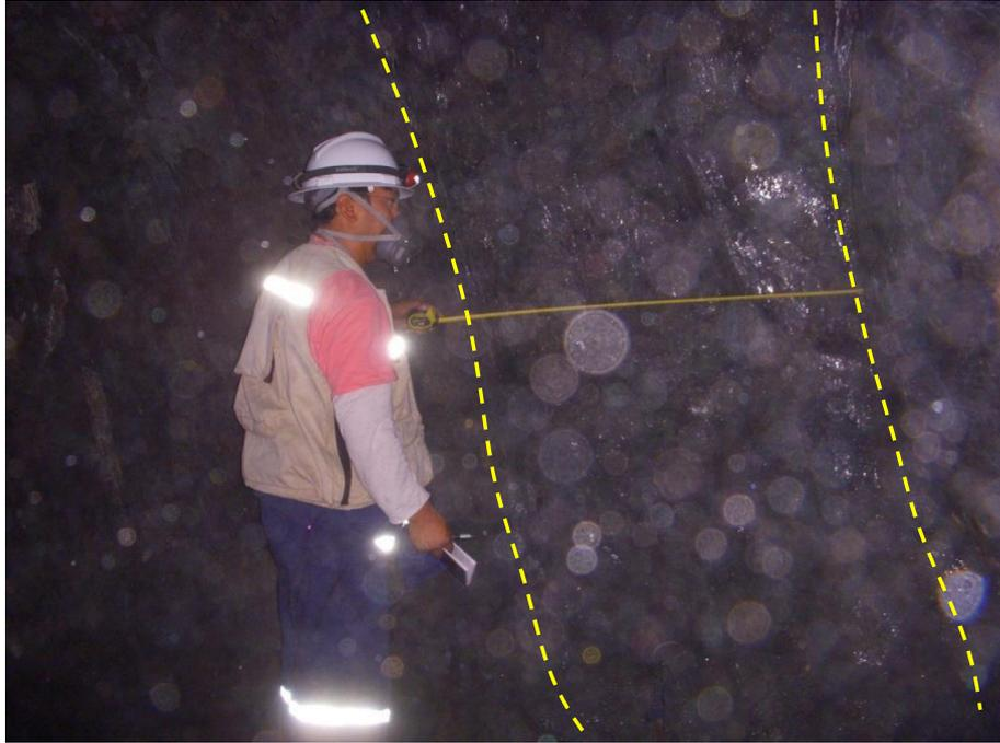
Foto 17. Nivel 1 Reina Cristina 4, Tomada en el tope de la labor del crucero 01, a los 85.3 metros, el ancho del manto en esta zona es de 1.10 metros pegado al flanco derecho de la labor.
