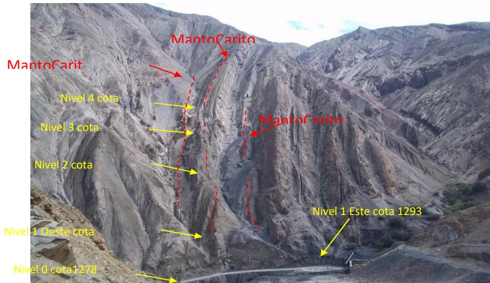
**Foto1.- Panorama del área de trabajo de Cocabal Área Vizcaya Obsérvese los 5 niveles de Galerías de extracción realizadas en los mantos, al este se tiene otra ocurrencia paralela con trabajo menos intenso.**
