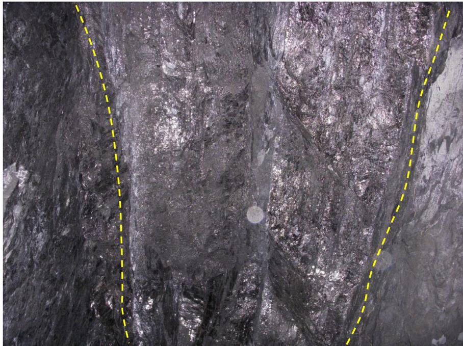
Foto 16. Nivel 1 Reina Cristina 4, A los 40 metros del crucero 01, se muestra el manto de carbón en toda su potencia, 1.30 metros de ancho pegado al flanco derecho de la labor. Foto mirando el techo.
