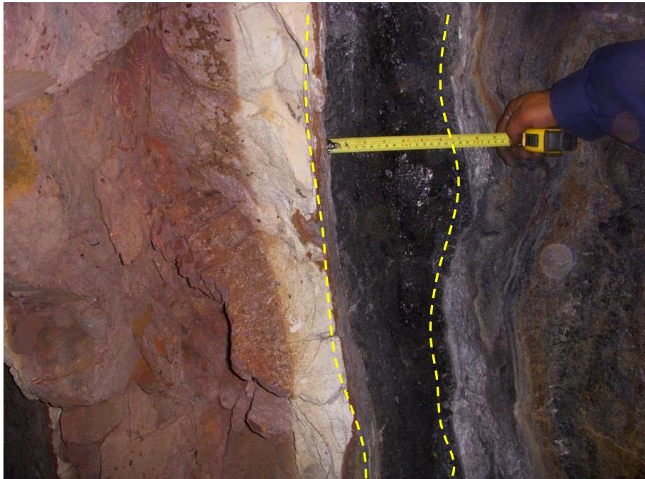
Foto 18. Nivel 2(a) Reina Cristina 4. Tomada en el tope de la labor a los 123.7 metros, la guía del manto tiene 20 cm. De ancho aproximadamente.
