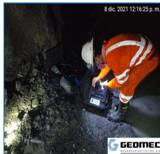
FOTO N° 4: Instalación de equipos Sismógrafos (GEOMEC) para medición de vibraciones inducidas por voladura. Rampa 8600 Frente completo.
