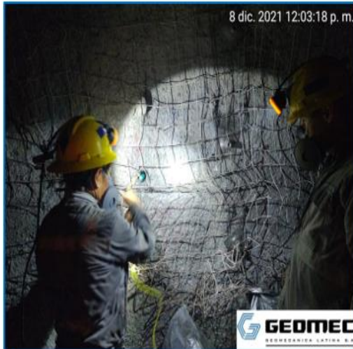
FOTO N° 5: Carguío de un taladro (SIMSA) para prueba especial en mineral y defenir "Tiempo de Retardo", Tajo 8670.
