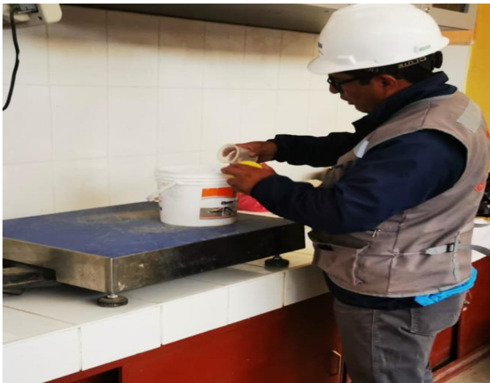
FOTOGRAFÍA N° 06: Proceso de la dosificación del mucílago de aloe para poder realizar nuestro concreto.
