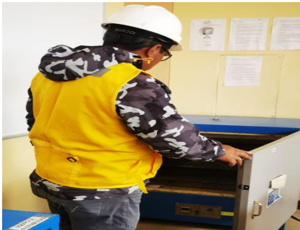
FOTOGRAFIA N°04: Proceso de la obtención del contenido de humedad de los agregados.
