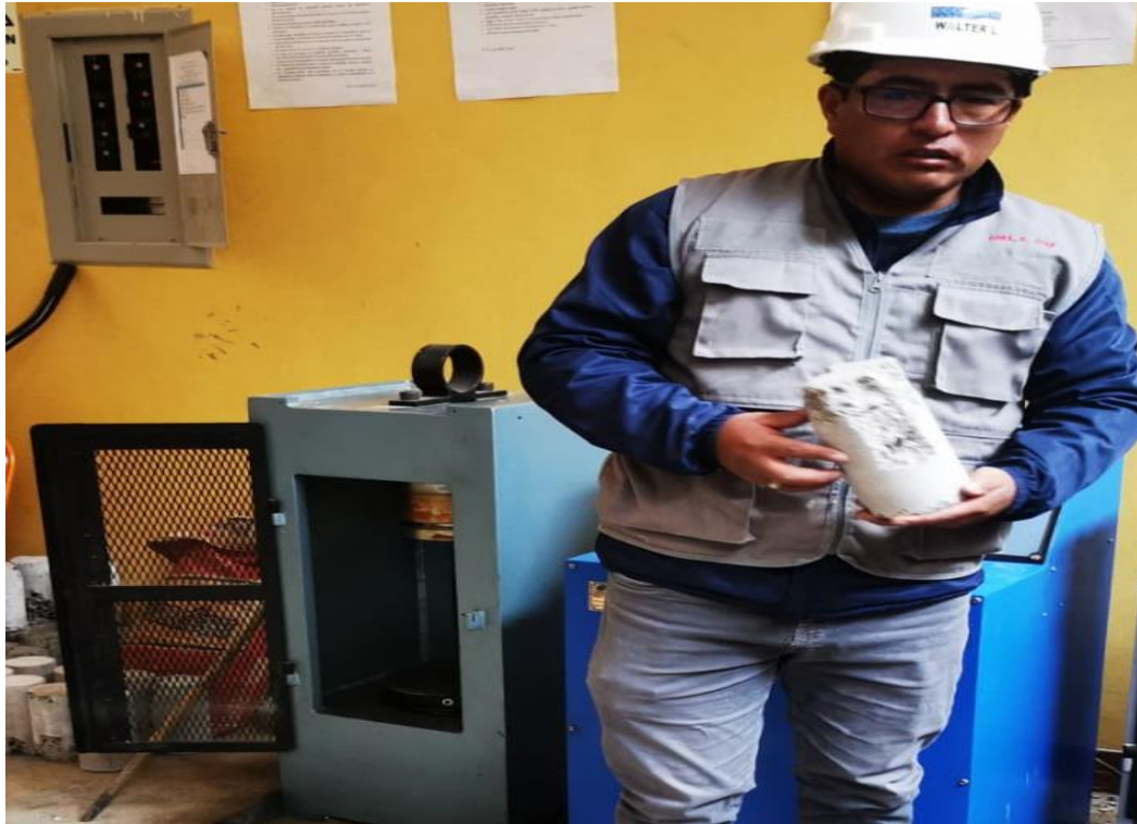
FOTOGRAFÍA N° 17: Verificación del tipo de corte de la probeta ensayada a la resistencia a compresión.
