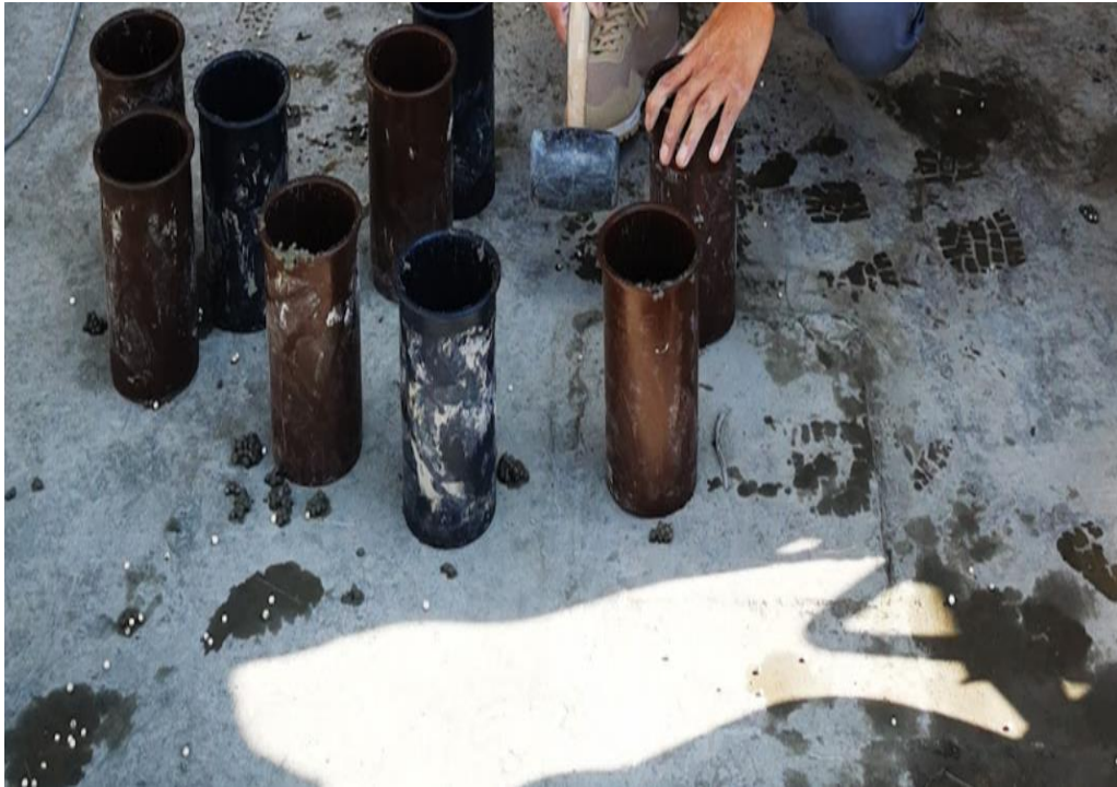
FOTOGRAFÍA N° 09: Proceso de la fabricación de las probetas de concreto.
