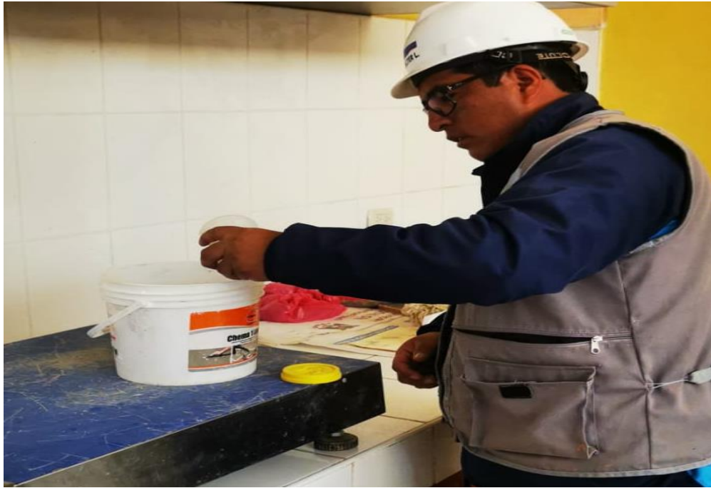
FOTOGRAFÍA N° 07: Proceso de la dosificación del mucílago de aloe para poder realizar nuestro concreto.
