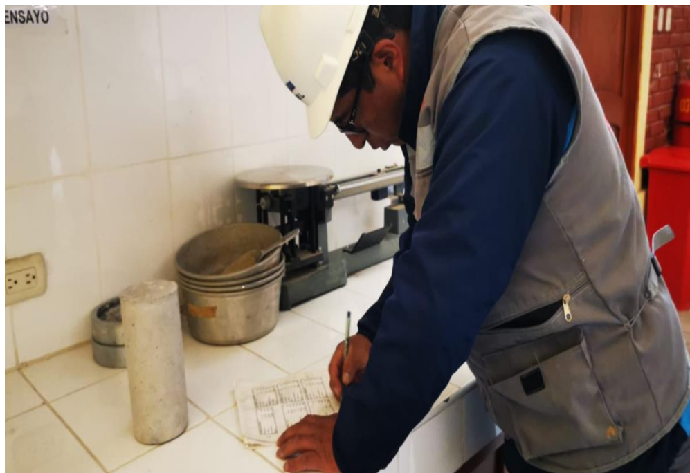
FOTOGRAFÍA N° 14: Toma de datos de las medidas y peso de las probetas para ensayar la resistencia a la compresión y resistencia de la tracción indirecta.
