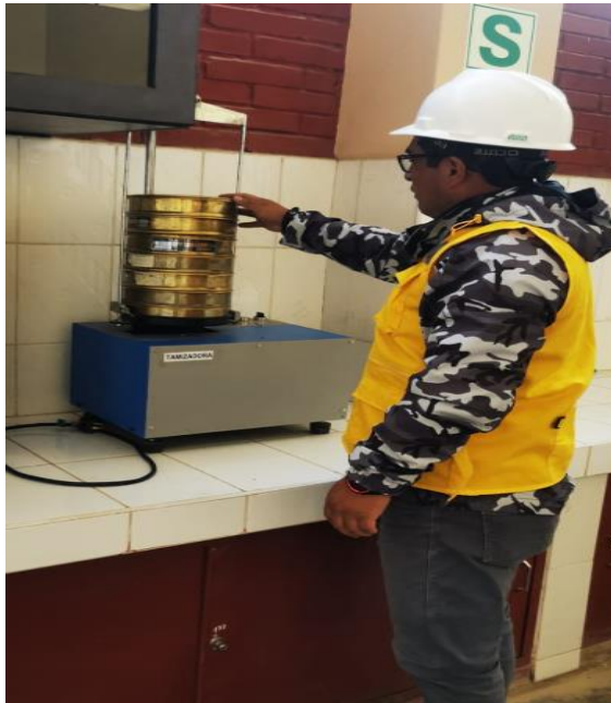
FOTOGRAFÍA N° 01: Proceso de análisis granulométrico de los agregados.
