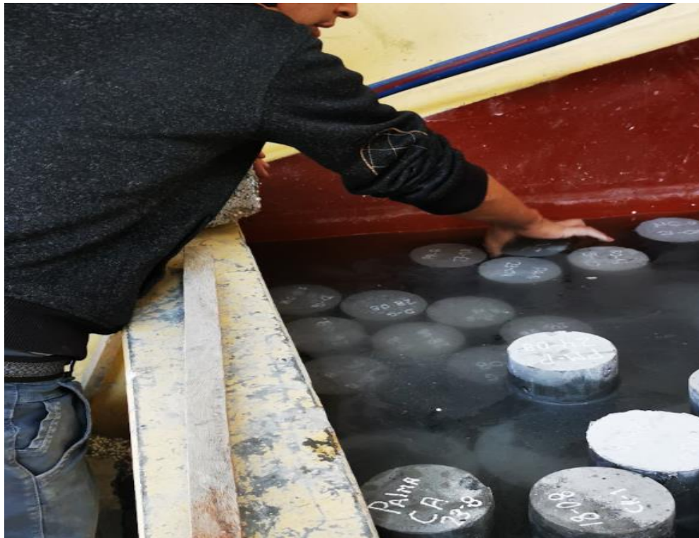
FOTOGRAFÍA N° 11: Proceso de curado de las probetas al 3.5% de sal.
