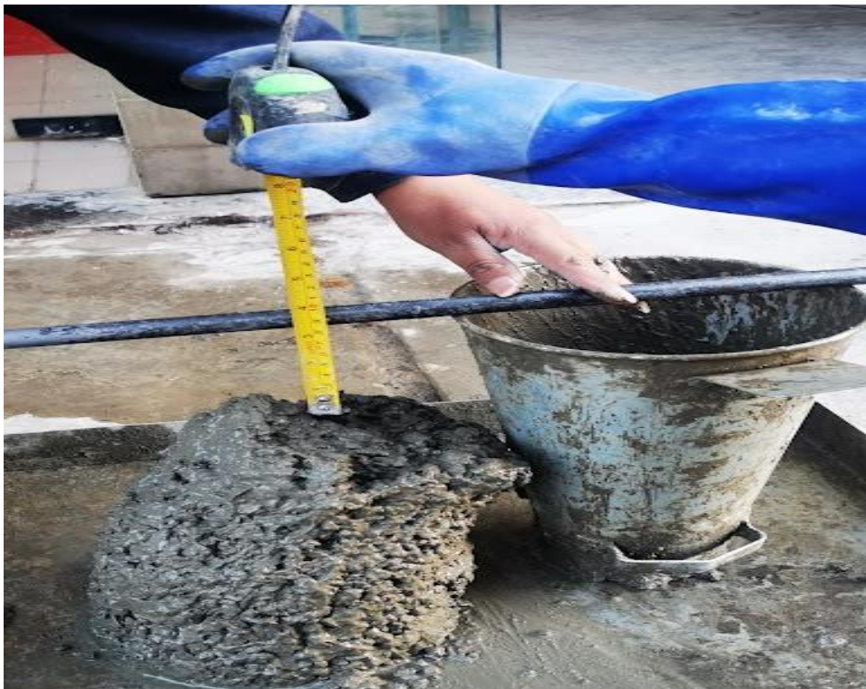
FOTOGRAFÍA N° 08: Proceso de la obtención del contenido de humedad de los agregados.
