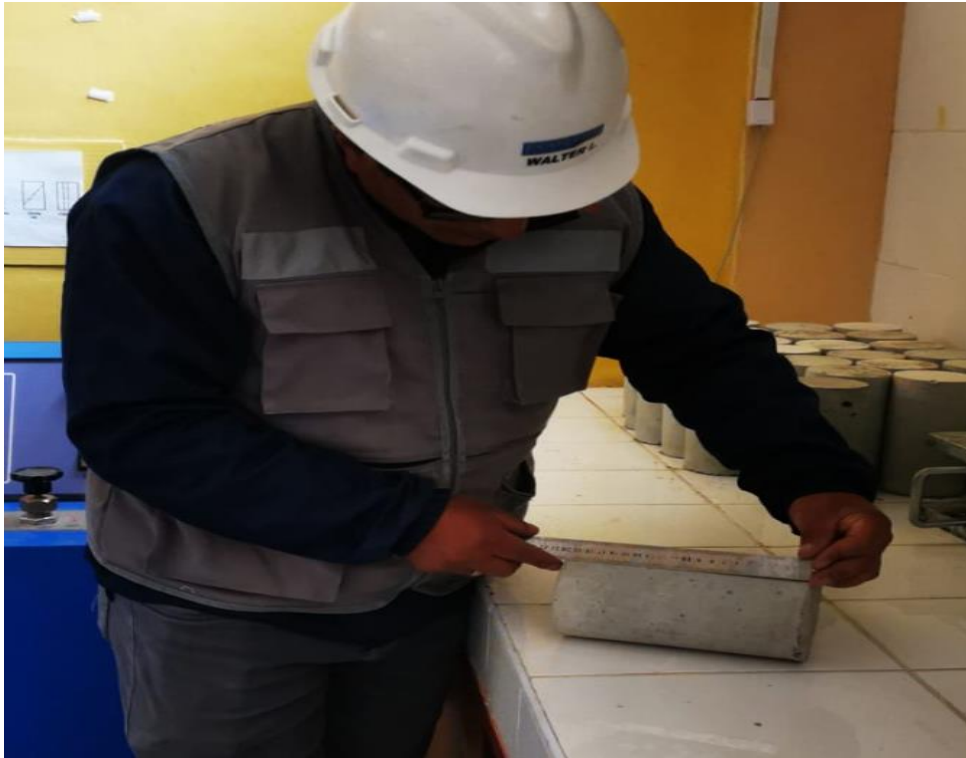
FOTOGRAFÍA N° 13: Proceso de toma de medidas y peso de las probetas para ensayar la resistencia a la compresión y resistencia de la tracción indirecta.
