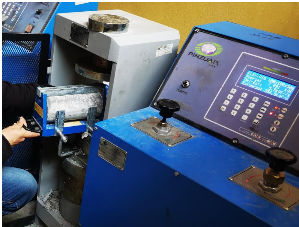
FOTOGRAFÍA N° 18: Proceso de ensayo a la resistencia de la tracción indirecta.
