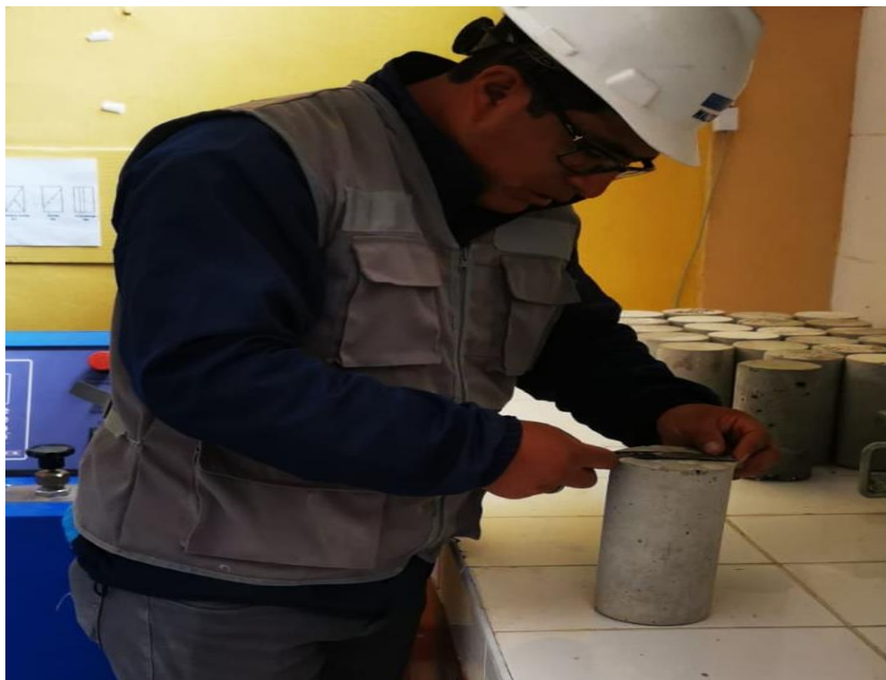
FOTOGRAFÍA N° 12: Proceso de toma de medidas y peso de las probetas para ensayar la resistencia a la compresión y resistencia de la tracción indirecta.
