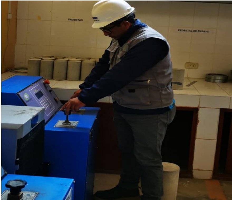
FOTOGRAFÍA N° 15: Control de velocidad de la aplicación de carga para ensayar la resistencia a la compresión y resistencia de la tracción indirecta.
