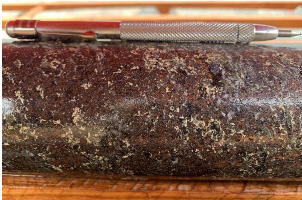
Fotografía 30: Masivo de esfalerita (-Fe) con carbonatos complejos de Fe-Mn, algunas zonas de moderada silisificación, primer estilo de mineralización.
