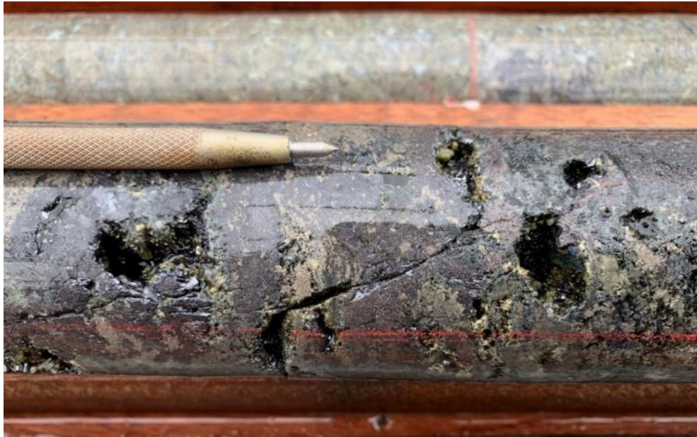
Fotografía 21: Estadío A, masivo de sulfuros con esfalerita y pirrotita, primer estilo de mineralización.
