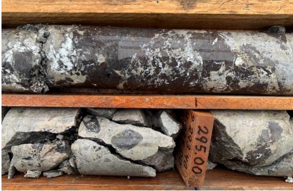
Fotografía 19: Reemplazamiento selectivo de esfalerita (+Fe) en brecha de caliza metasomatisada por carbonatos de Fe-Mn, segundo estilo de mineralización.
