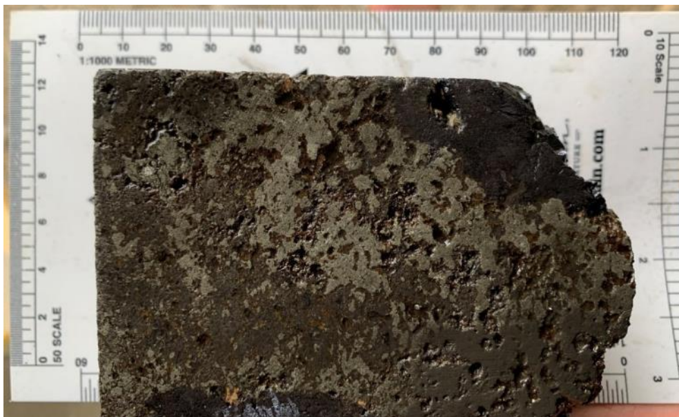
Fotografía 4: Sobreimposición de pirita sobre esfalerita (+Fe) y pirrotita, textura tipo vuggy, primer estilo de mineralización.
