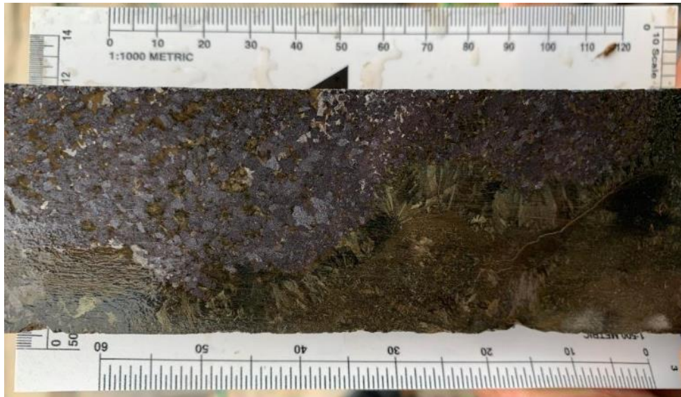
Fotografía 9: Reemplazamiento de esfalerita (+Fe) sobre los relictos de la mineralización skarn (actinolita-tremolita-magnetita), segundo estilo de mineralización.
