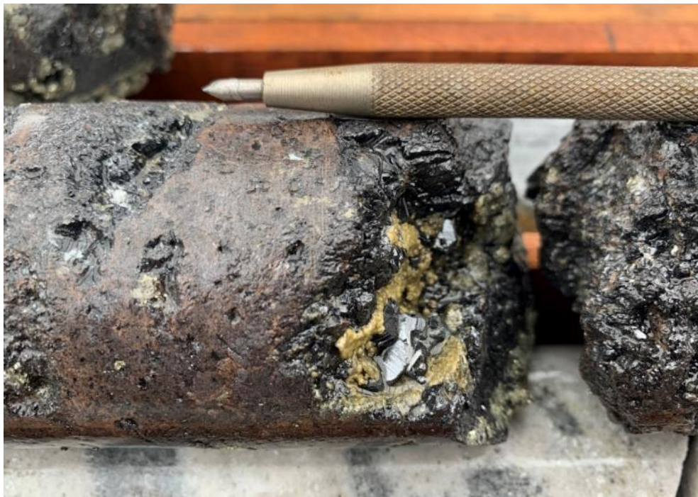
Fotografía 16: Masivo de esfalerita (+Fe) con parches de esfalerita (-Fe) y siderita rellenando oquedades, primer estilo de mineralización.
