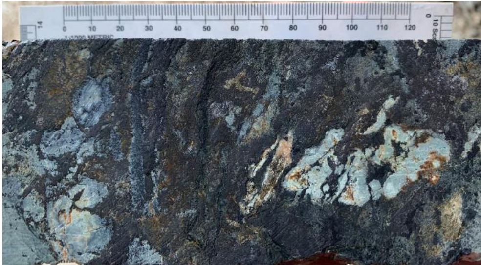
Fotografía 7: Sobreimposición de esfalerita (+Fe) sobre mineralización del estadio Pre-A (magnetita-clorita), relictos de brecha de caliza, segundo estilo de mineralización.
