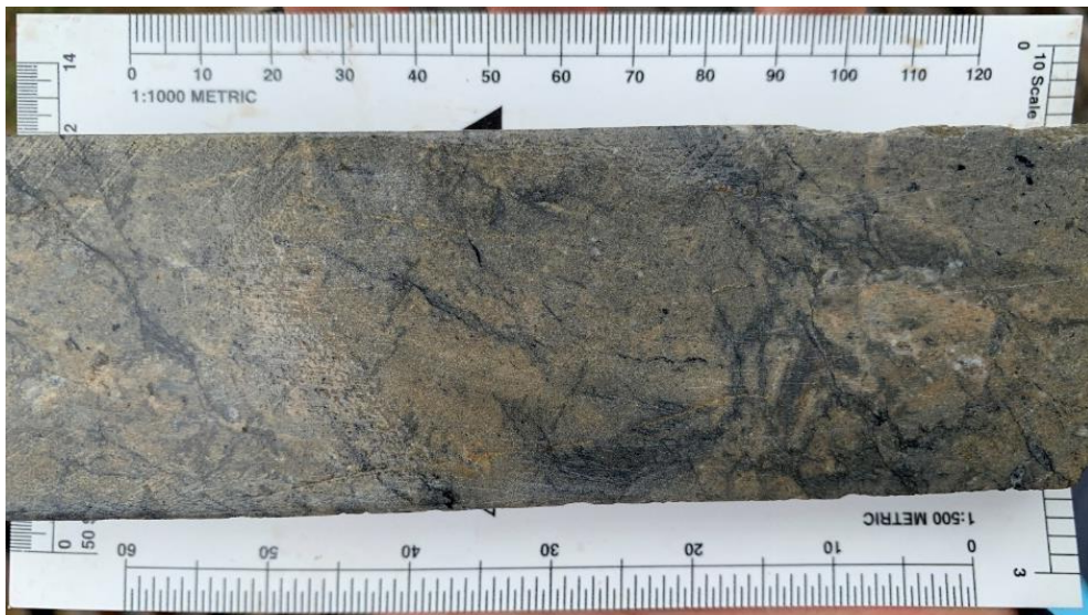
Fotografía 285: Caliza metasomatisada por carbonatos complejos Mn-Fe, fina disseminación de magnetita asociado a clorita, segundo estilo de mineralización.
