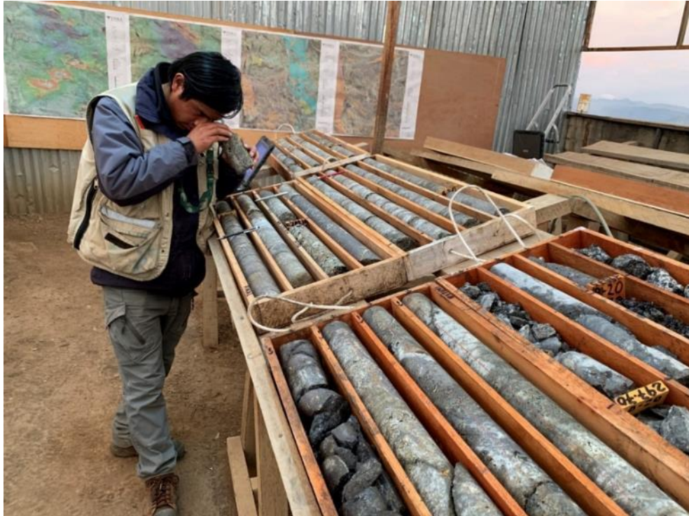
Fotografía 1: Logueo geológico de testigos de perforación.
