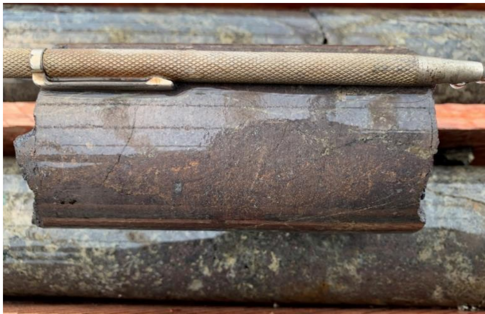
Fotografía 14: Masivo de esfalerita (+Fe) del Estadio B con finas venillas de carbonato de Fe-Mn del Estadio C, primer estilo de mineralización.
