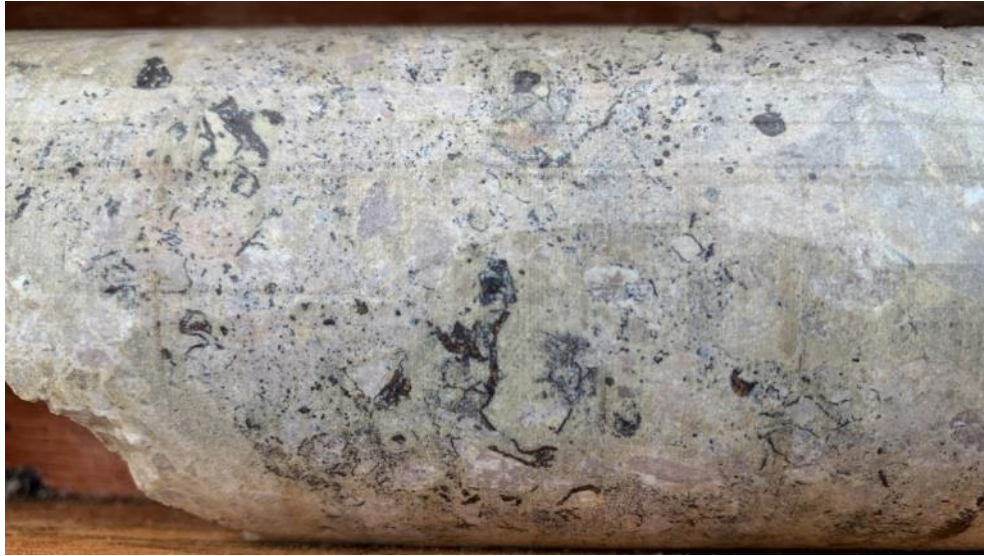
Fotografía 27: Brecha de caliza metasomatisada con parches de esfalerita (-Fe), segundo estilo de mineralización.
