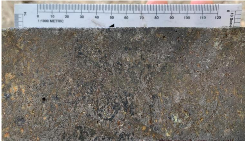
Fotografía 11: Sobreimposición de pirrotita-arsenopirita (Estadío A) sobre magnetita (Estadío Pre-A) y posterior pirita (Estadío B), primer estilo de mineralización.
