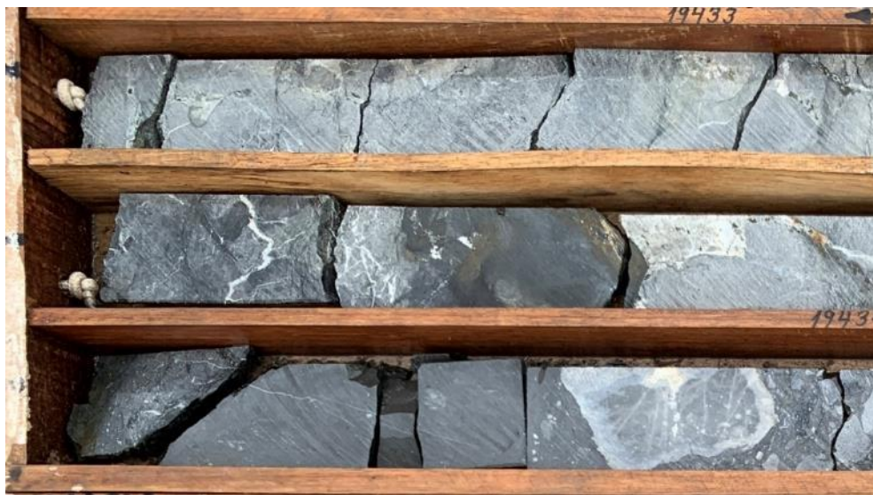
Fotografía 337: Venilleo de carbonato blanco complejo de Mn-Fe en caliza brechada, segundo estilo de mineralización.
