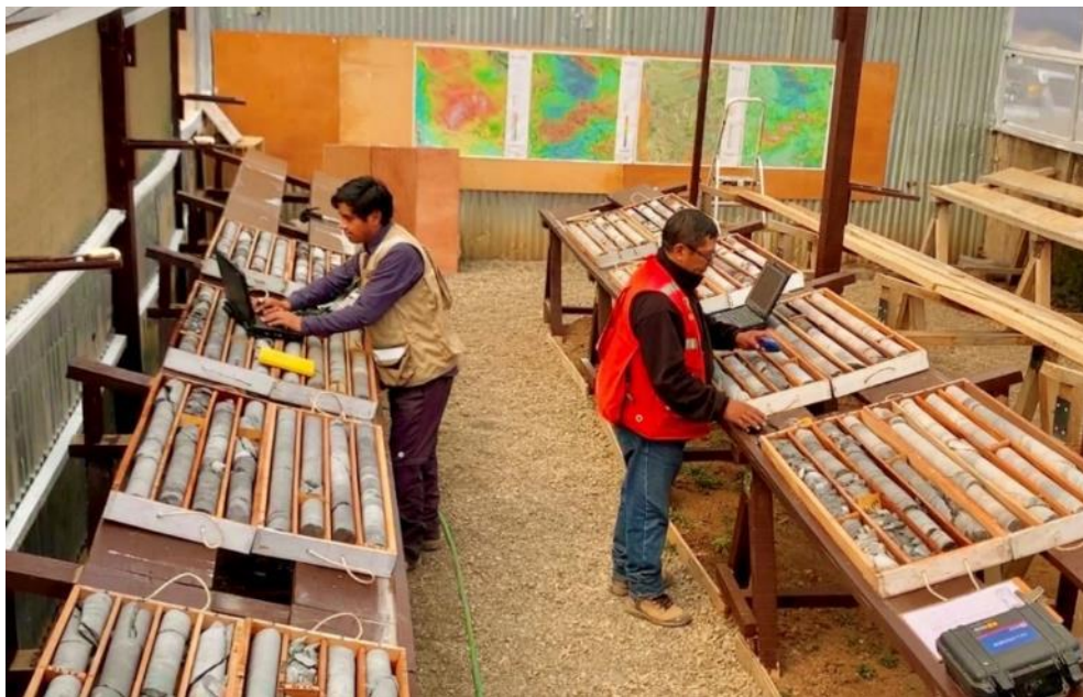
Fotografía 2: Logueo geológico (izquierda) y lectura de dirección de estructuras con IQLogger derecha).
