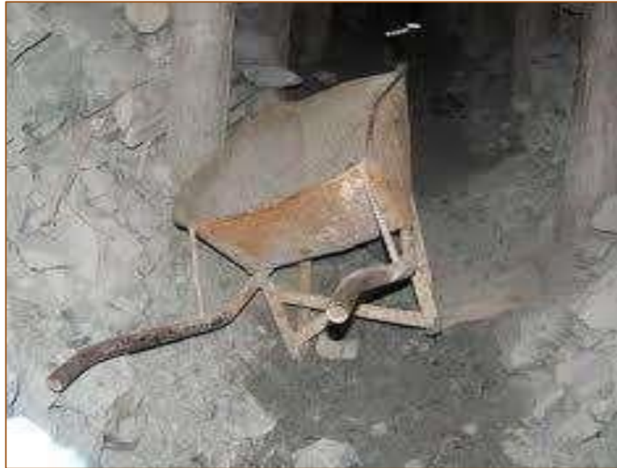
Figura 21. Limpieza de mineral con carretilla.
