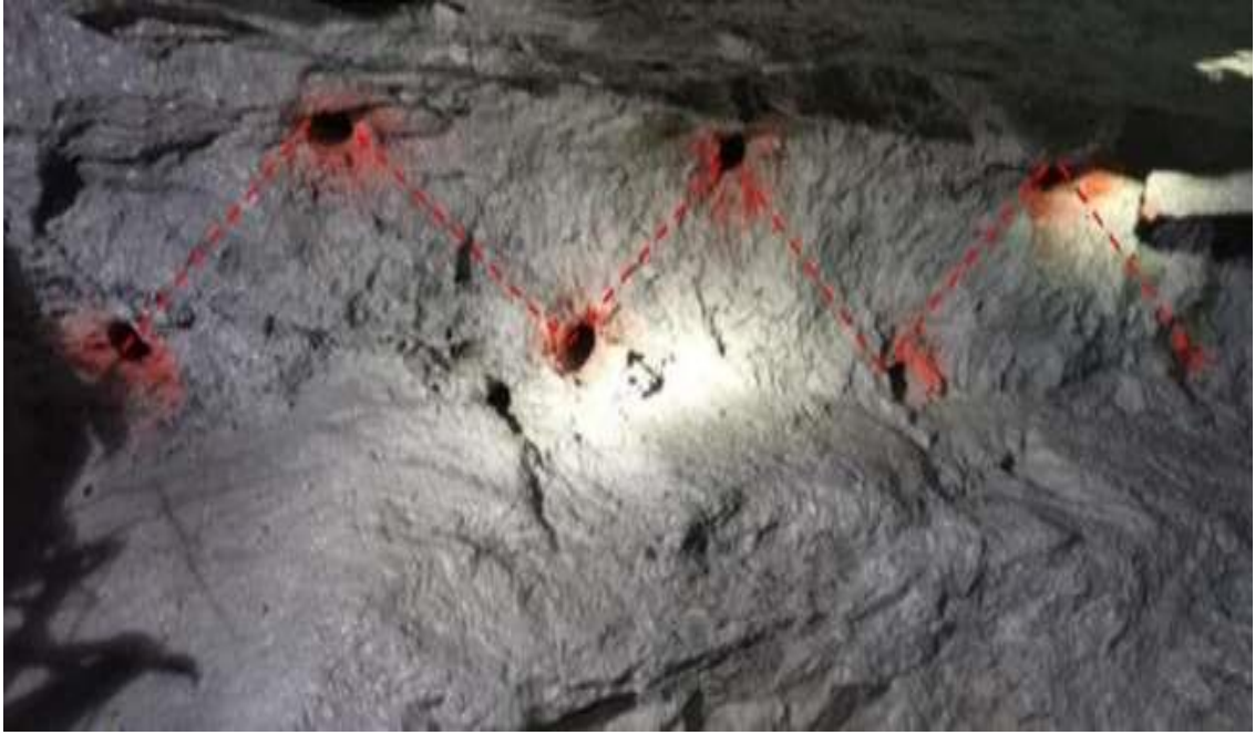
Figura 42. Malla de perforación.
