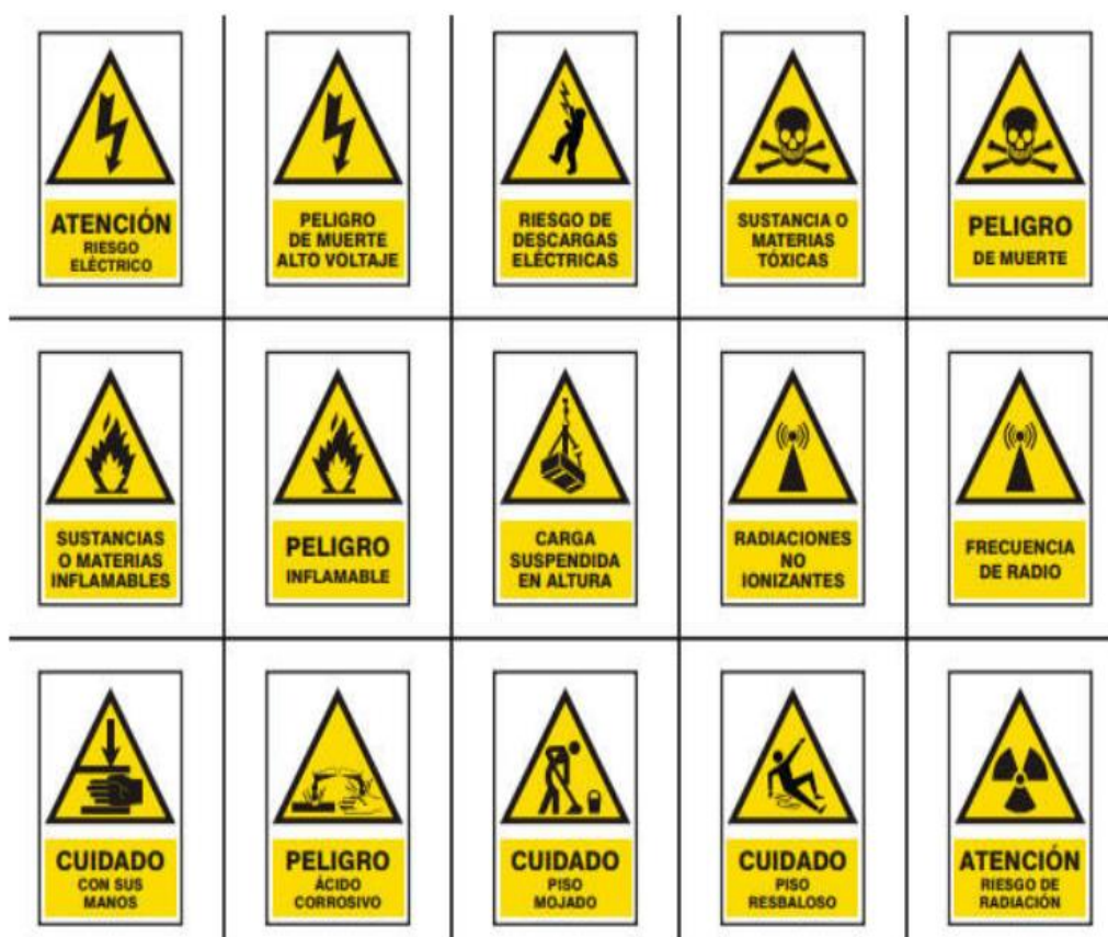
Figura 13. Señales de advertencia.
