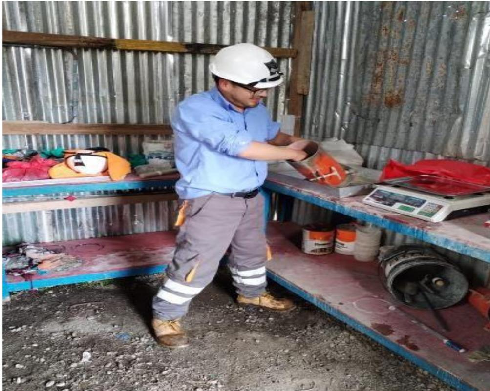
**Fotografía N°1: Proceso de enrasado del molde**
