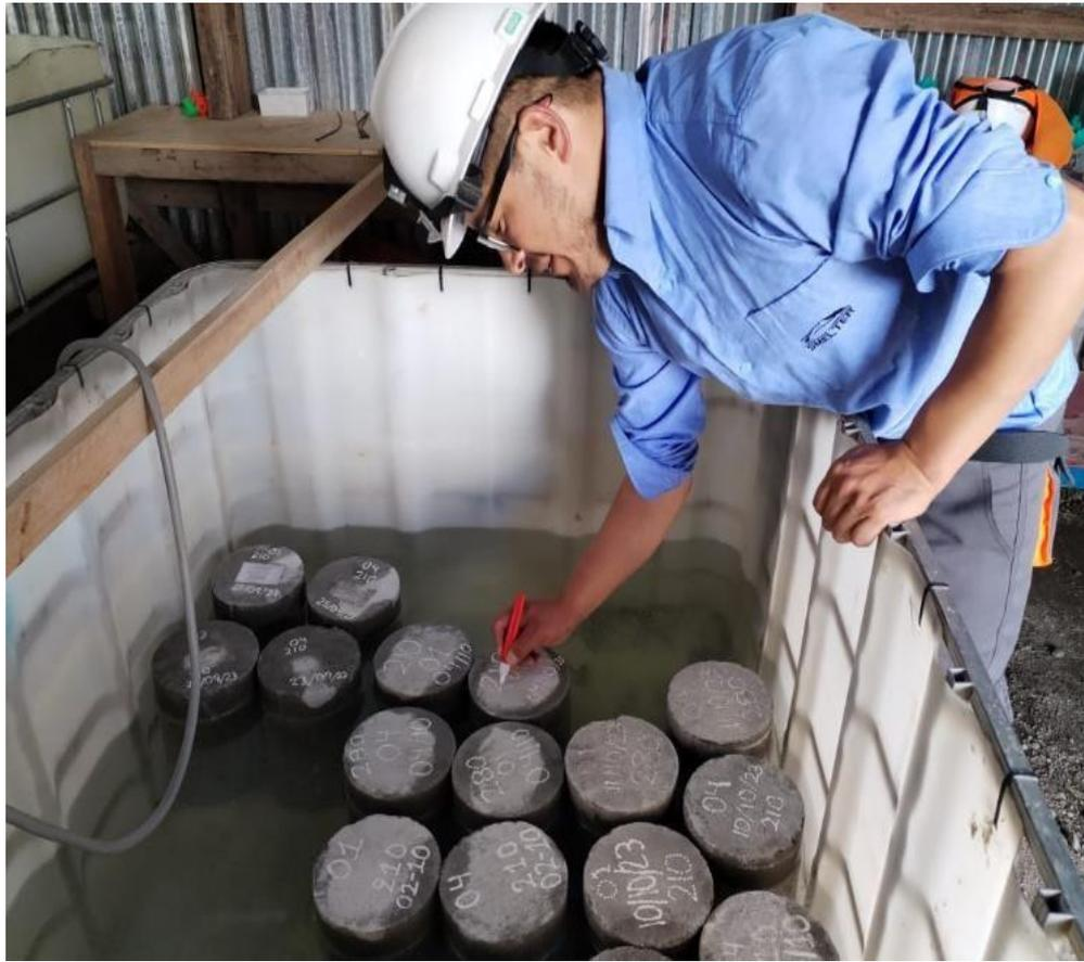
**Fotografía N°3: Proceso de toma de códigos de las probetas**
