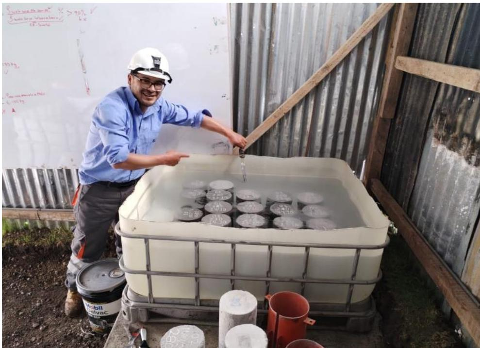
**Fotografía N°2: Proceso de curado de las probetas**
