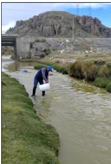
10.a. Inyección de Trazador salino.
