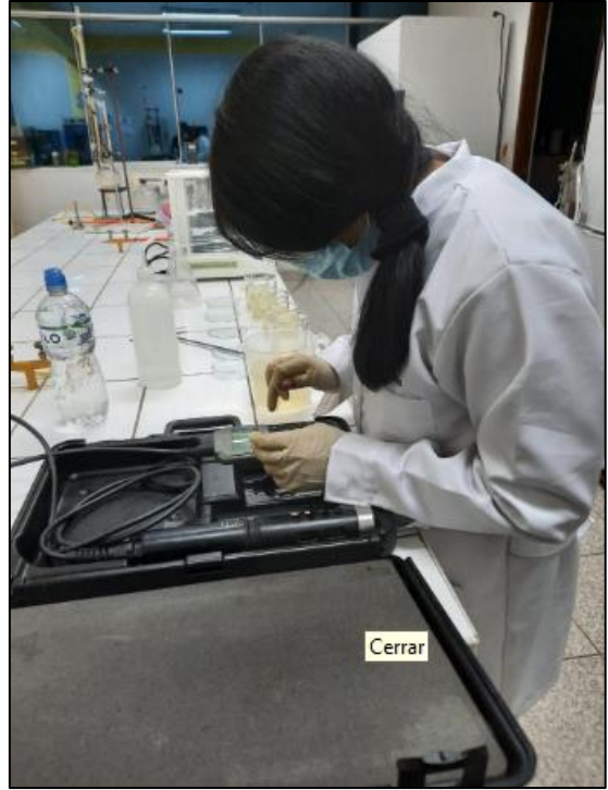
Imagen N° 14. Calibración de Conductividad – Concentración en el laboratorio.
