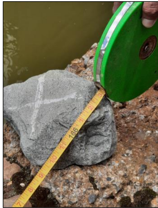
Imagen N° 10. Medición de tramos y ubicación de punto de inyección de trazador salino.
