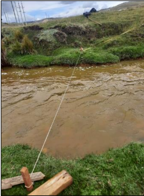
Imagen N° 12. Medición de área transversal del río.
