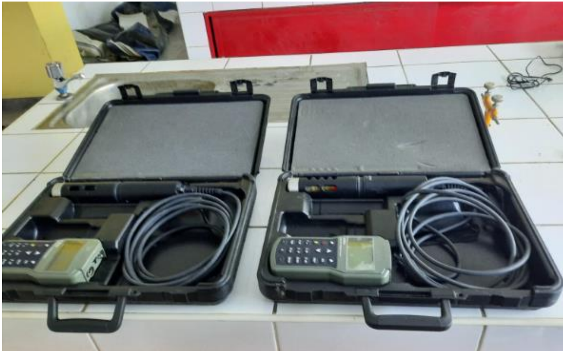
Imagen N° 8. Multiparámetros usados para las mediciones en campo.
