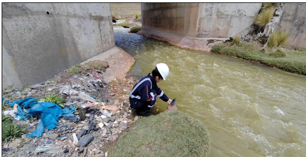
Imagen N° 6: Punto de inyección de trazadores.
