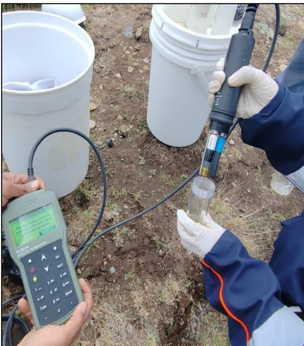
Imagen N° 11. Calibración de Multiparámetros.
