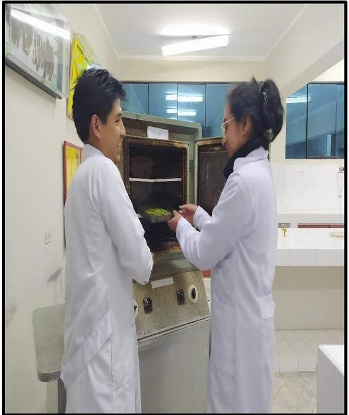
Fig. 20 - 21. Inserción de muestras al horno para secado a 140 °C por 40 minutos.
