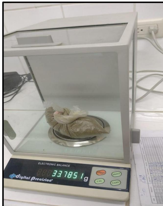
**Fig. 36.** Pesado de muestras obtenidas luego post desecación a  $140^{\circ}\text{C}$  por 40 minutos.
