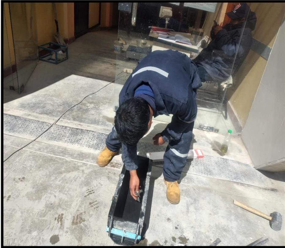
**Fotografía N°13.-** Se realiza la preparación del molde de la viga (0.55x0.15) donde se colocara la mezcla del concreto.
