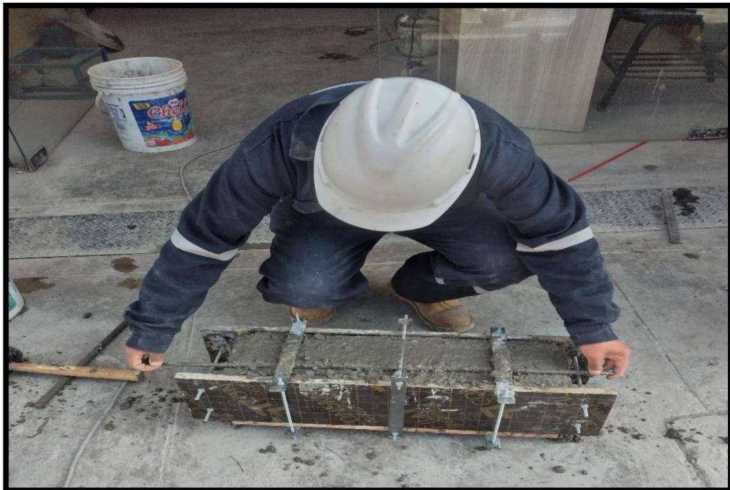
**Fotografía N°28.-** Se aprecia el nivelado de la mezcla del concreto con la ayuda de la varilla de acero.
