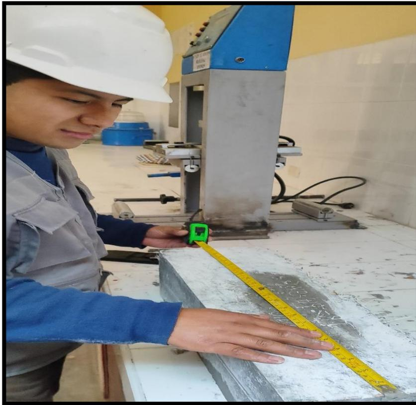
**Fotografía N°31.-** Se realiza la medición del largo de la viga de concreto a ser ensayada.
