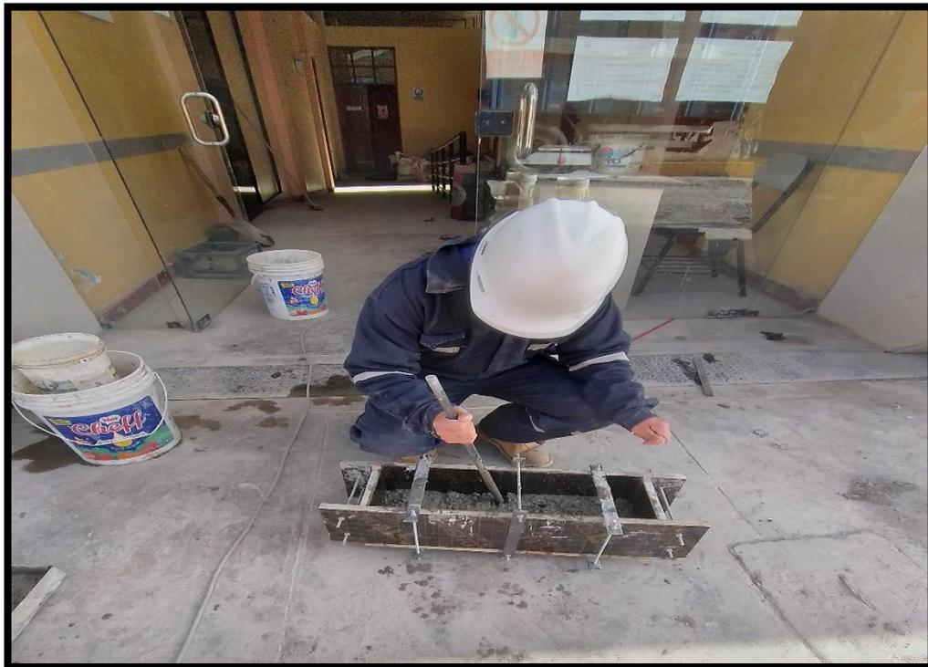
**Fotografía N°26.-** Se aprecia el llenado del concreto al molde de la viga así como de su compactado.
