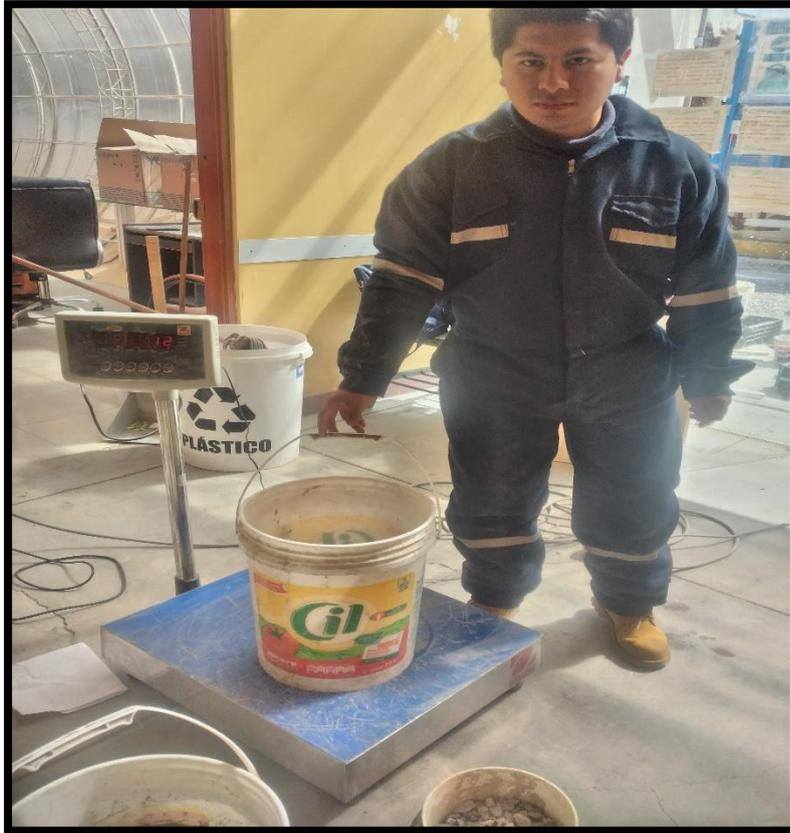
**Fotografía N°11.-** Se observa la medición en peso del agregado grueso.
