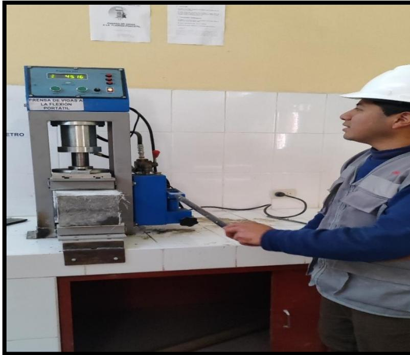
**Fotografía N°35.-** La prueba consiste en aplicar presión en el centro superior de la viga la cual se encuentra soportada en dos apoyos esquinales hasta llegar a la rotura.
