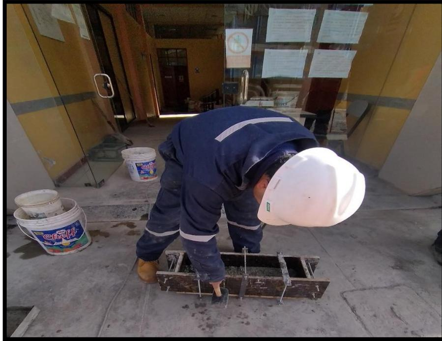
**Fotografía N°27.-** Se aprecia que con la ayuda de un mazo se realiza el golpeado exterior para que el concreto adquiera la forma del molde.
