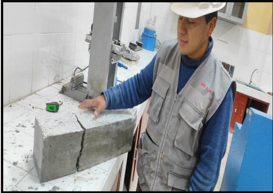
**Fotografía N°41.-** Se aprecia la falla en la viga el cual contiene la cantidad mínima de las fibras de acero.
