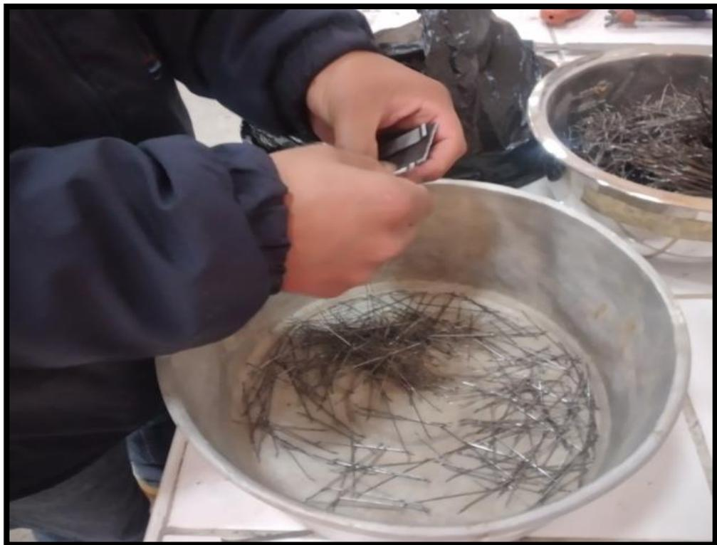
**Fotografía N°04.-** Resultado de la separación de las fibras de acero.
