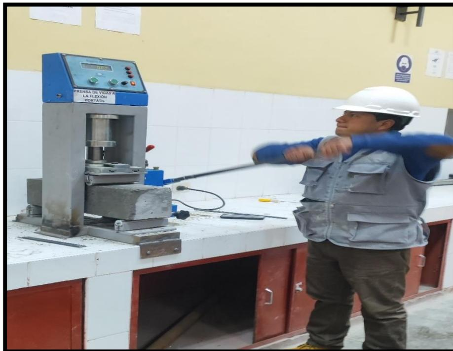
**Fotografía N°36.-** Se aprecia que cada vez que se hace el movimiento en el brazo de palanca la maquina ejerce una presión que es registrada hasta el punto de rotura.
