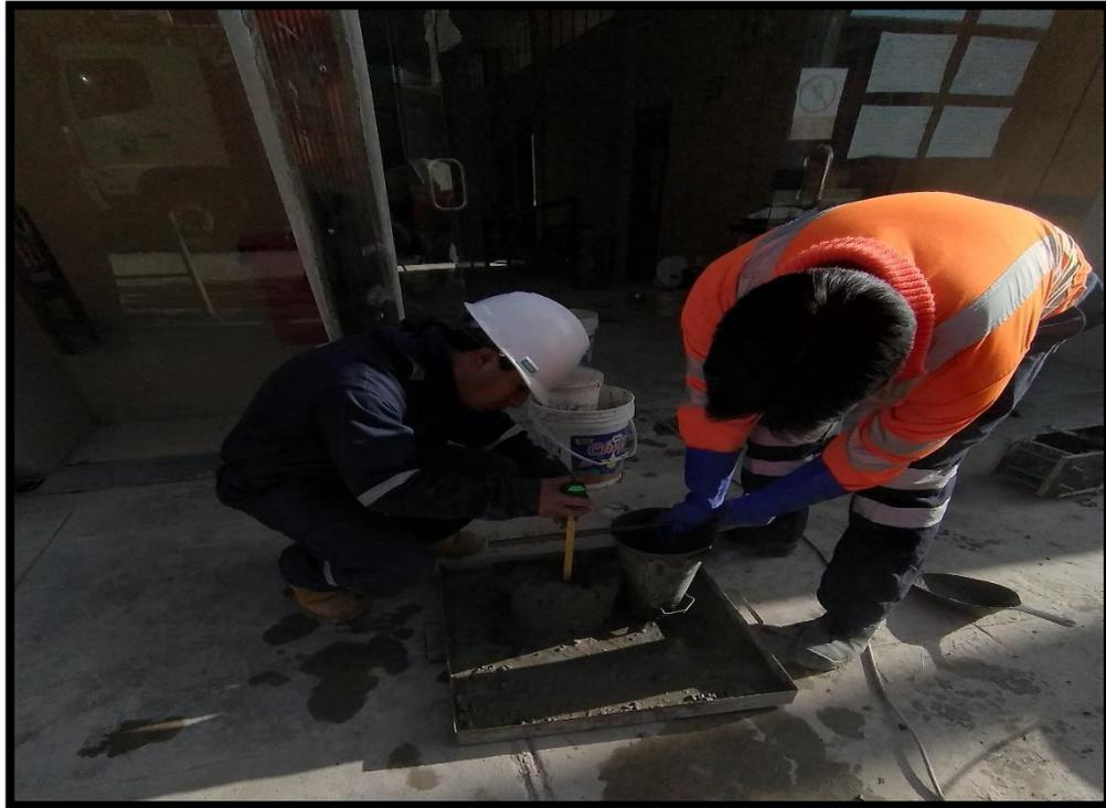
**Fotografía N°25.-** Se aprecia que con la ayuda de una persona se procede a realizar la medición del slump.
