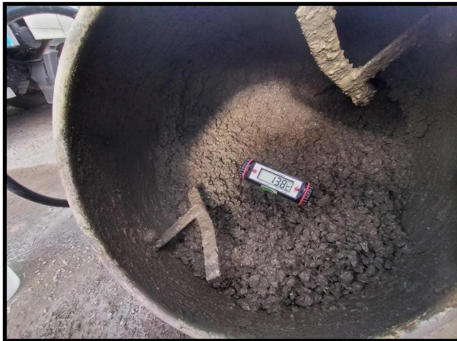
**Fotografía N°22.-** Se aprecia que la medición de temperatura es importante para el evitar el congelamiento del concreto o la evaporación del mismo.
