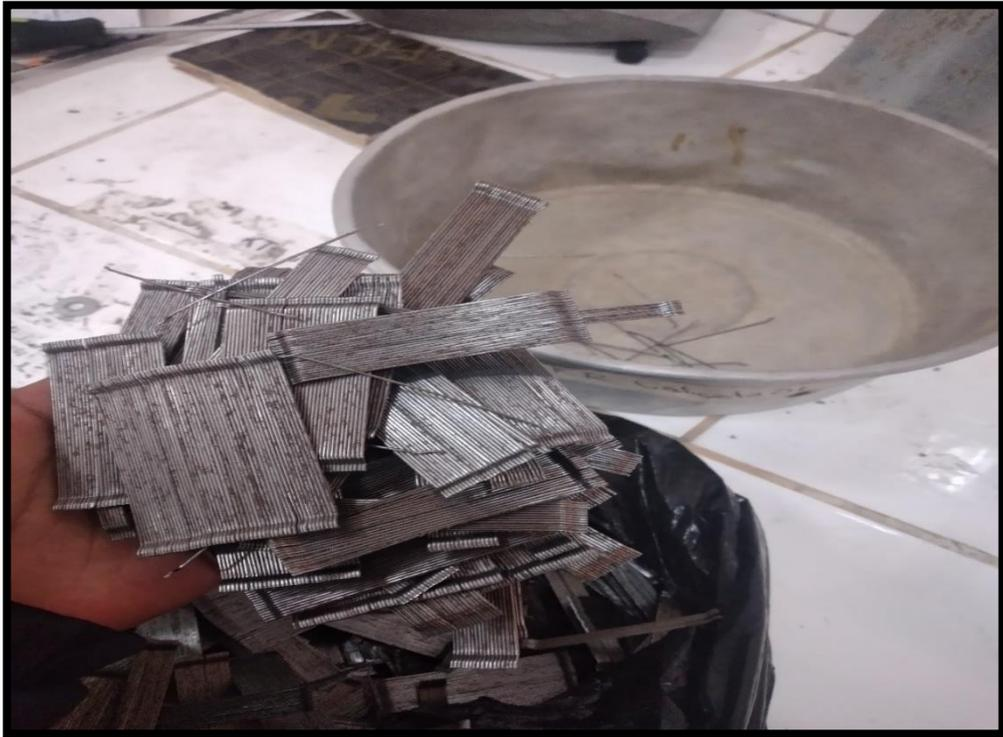
**Fotografía N°01.-** Se aprecia las características de las fibras de acero
