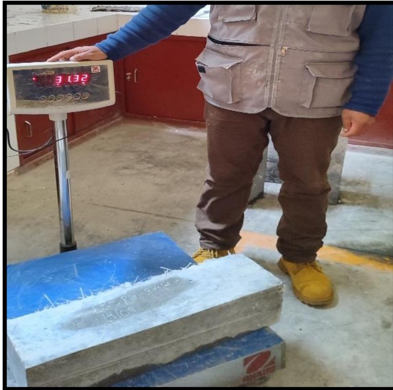
**Fotografía N°33.-** Se realiza la medición del peso de la viga de concreto a ser ensayada.
