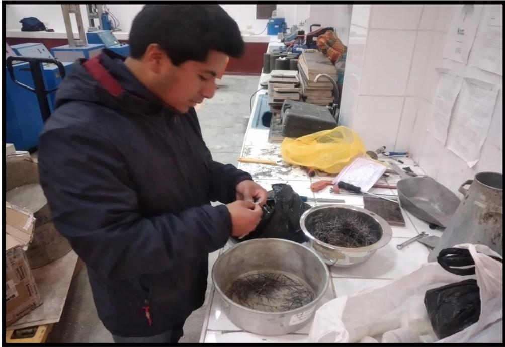
**Fotografía N°03.-** Se aprecia el proceso de separación de las fibras de acero y macrofibras sintéticas para el pesado respectivo.
