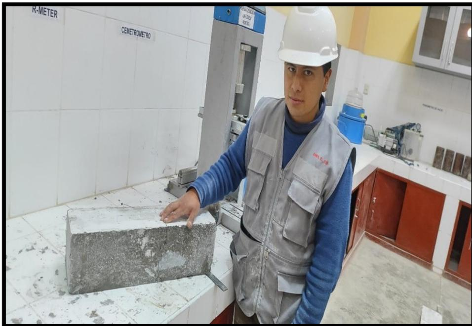
**Fotografía N°42.-** Se aprecia la falla en la viga el cual contiene la cantidad máxima de las macrofibras sintéticas.
