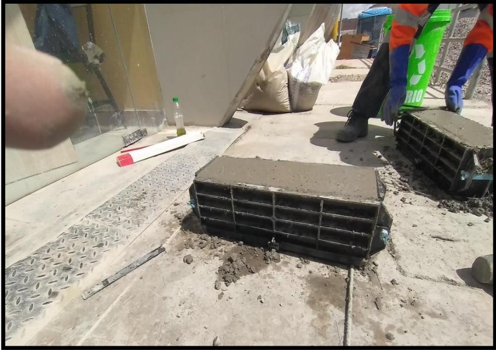
**Fotografía N°29.-** Se aprecia el producto final del mezclado debidamente colocado en los moldes respectivos.
