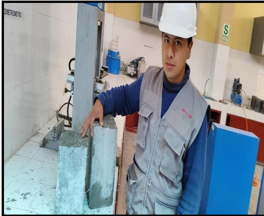
**Fotografía N°39.-** Se aprecia la rotura total de la viga el cual contiene la cantidad mínima de las macrofibras sintéticas.
