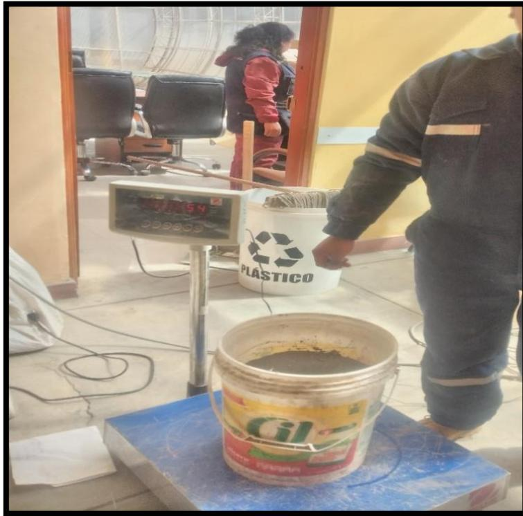
**Fotografía N°09.-** Se observa la medición en peso del cemento.
