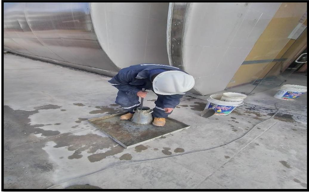
**Fotografía N°23.-** Se aprecia el compactado con la varilla de acero para el control del asentamiento (slump) del concreto realizado en el cono de abrams.
