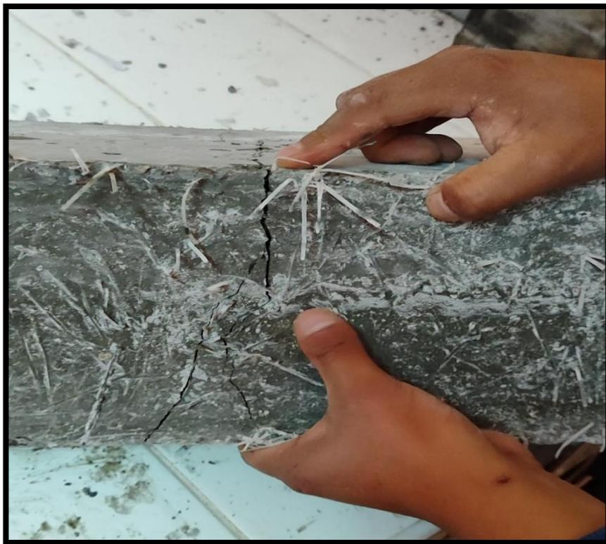
**Fotografía N°38.-** Se aprecia la rotura de la viga ensayada el cual contiene las macrofibras sintéticas.
