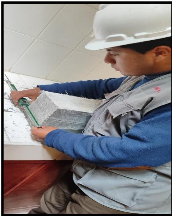
**Fotografía N°30.-** Se realiza la medición del ancho de la viga de concreto a ser ensayada.
