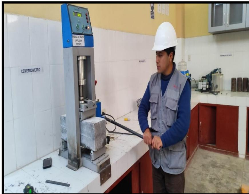
**Fotografía N°34.-** Se realiza la prueba de la resistencia a flexión a la viga de concreto.
