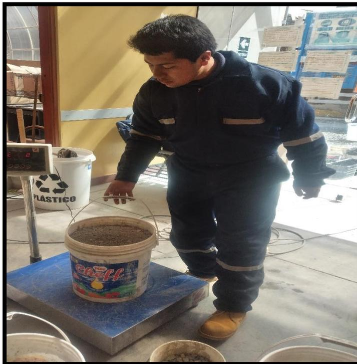
**Fotografía N°10.-** Se observa la medición en peso del agregado fino.
