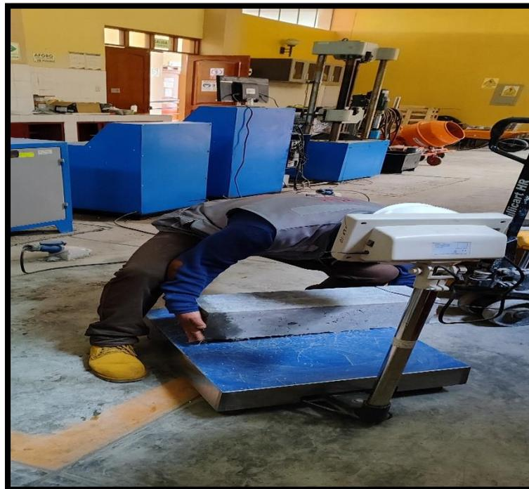
**Fotografía N°32.-** Se procede a realizar el peso de la viga antes de ser ensayada.
