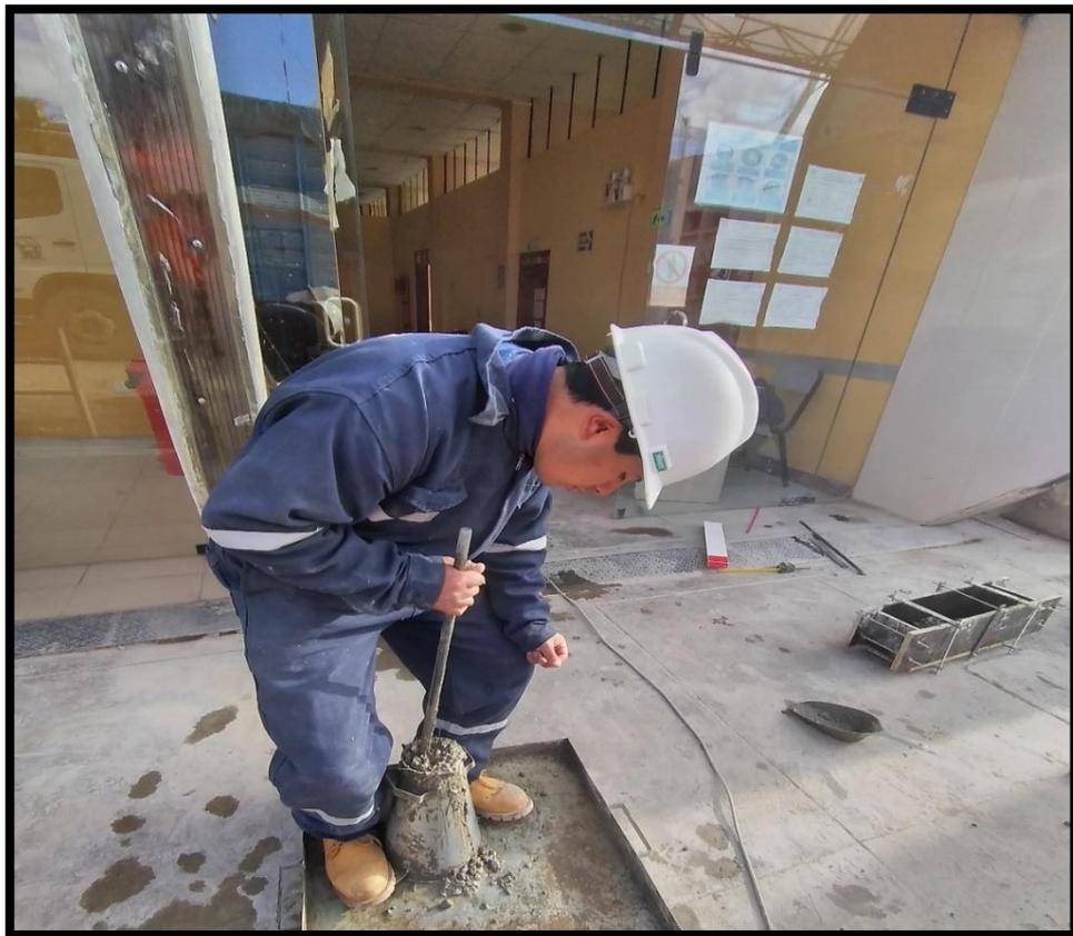
**Fotografía N°24.-** Se aprecia que el proceso de compactación se realiza en 03 partes hasta completar el cono de abrams.
