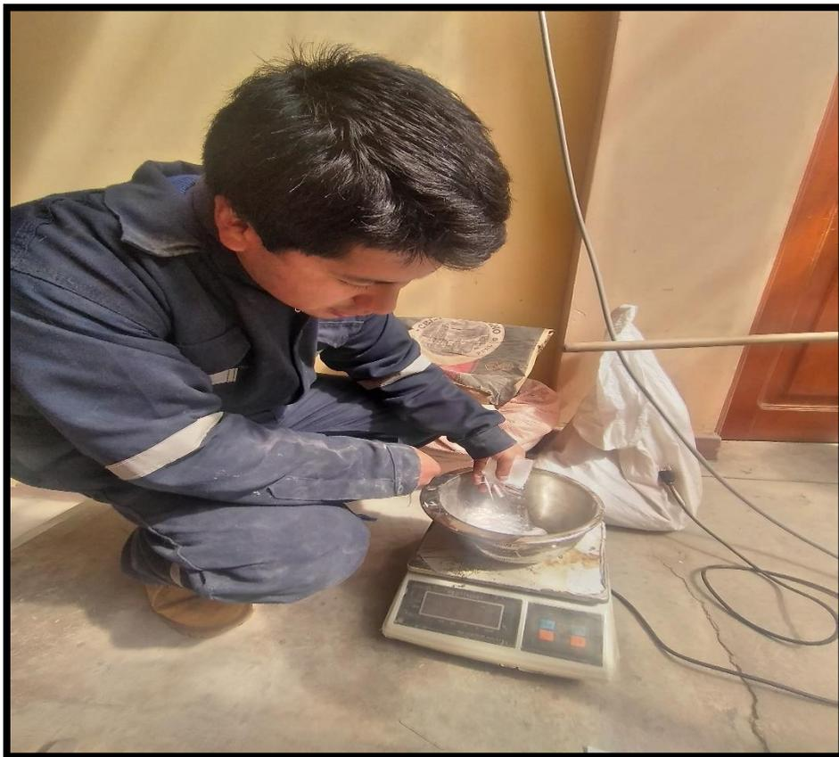
**Fotografía N°08.-** Se observa la medición en peso de las macrofibras sintéticas.
