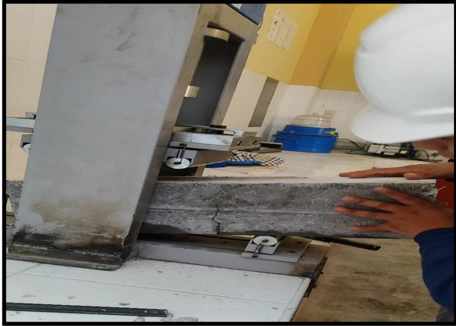
**Fotografía N°37.-** Se aprecia la falla de la viga en el centro de su longitud.
