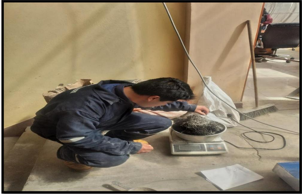
**Fotografía N°07.-** Se observa la medición en peso de las fibras de acero.
