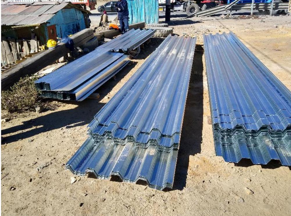
*Ilustración 34 Placa colaborante ACERO DECK AD-600 - Fuente: propia*
