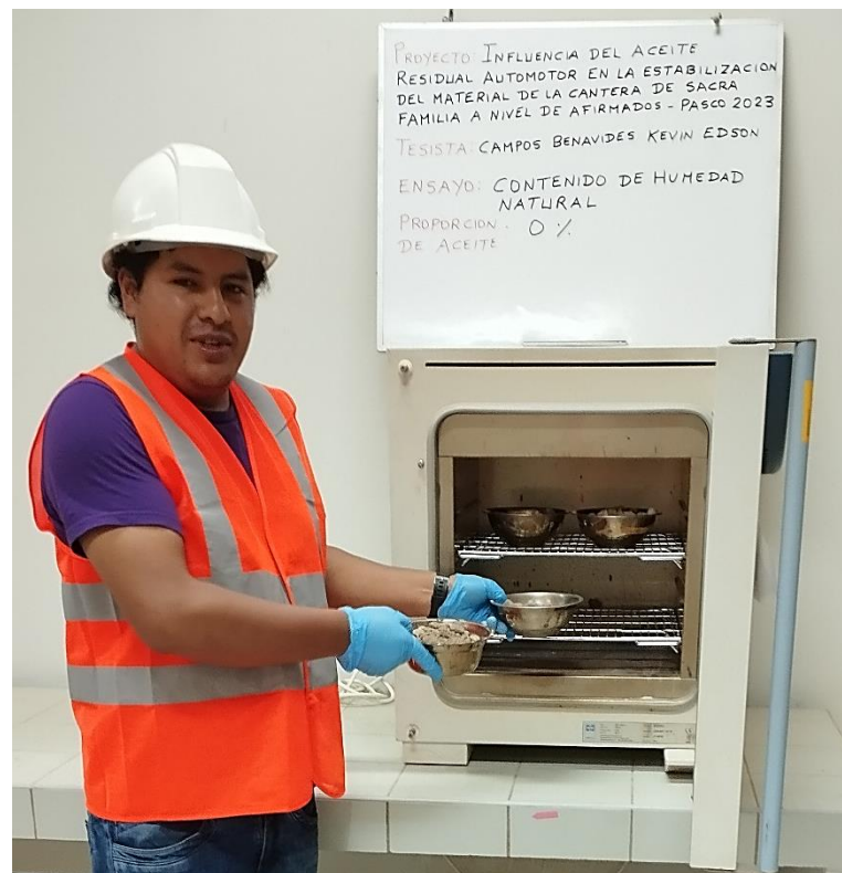
FOTOGRAFIA N°6: Colocación en el horno de muestra para determinación del contenido de humedad
