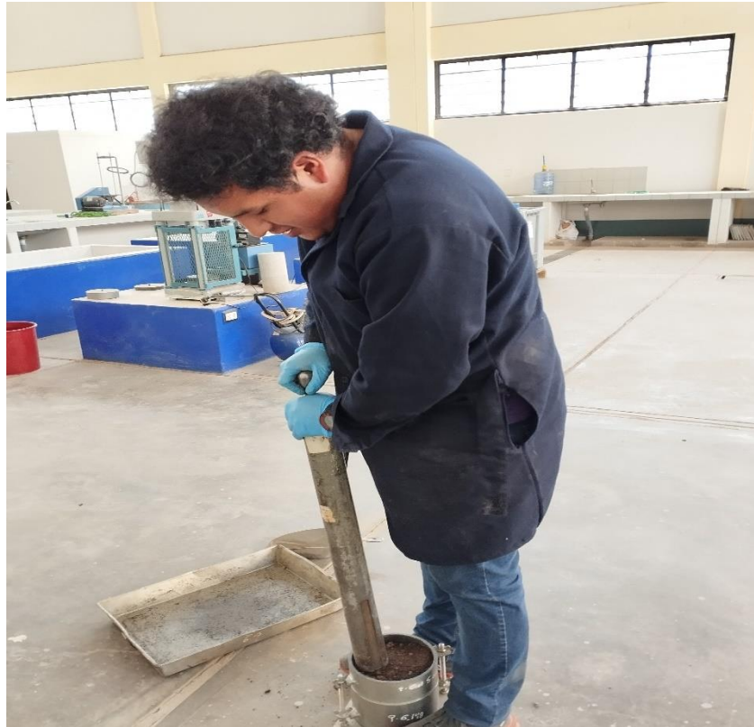
FOTOGRAFIA N°21: Compactación del suelo con martillo Proctor
