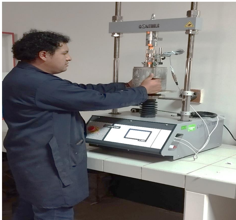
FOTOGRAFIA N°26: Colocación del molde para ensayo de Penetración del suelo afirmado
