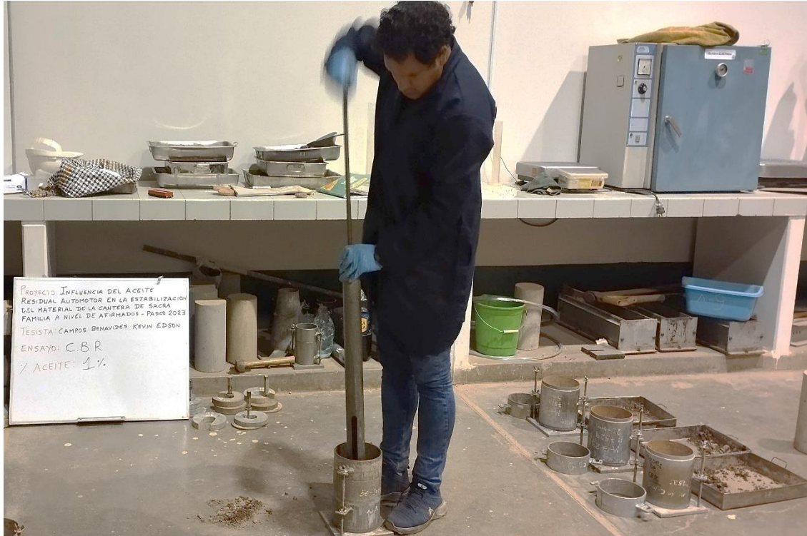
FOTOGRAFIA N°24: Compactación a los 10, 25 y 56 golpes
