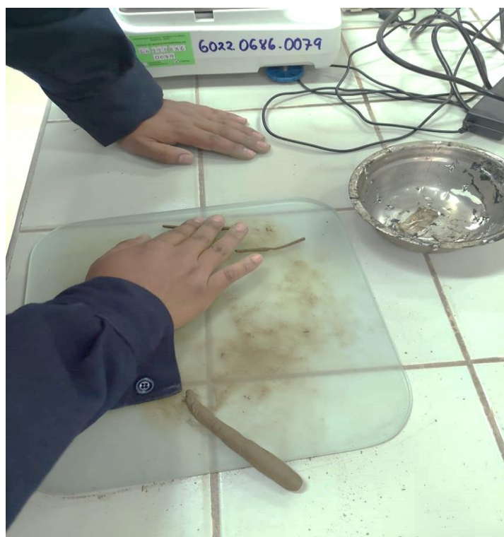
FOTOGRAFIA N°17: Amasado de la muestra para limite plástico
