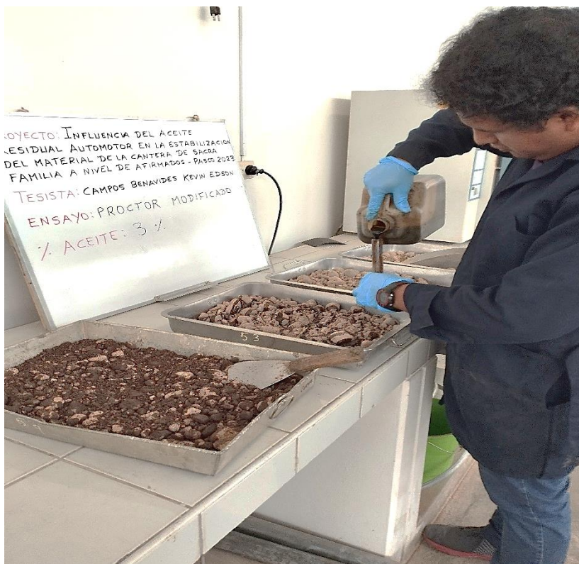
FOTOGRAFIA N°19: Materiales ensayo de Proctor modificado
