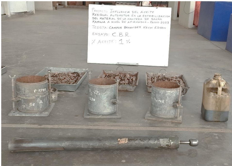
FOTOGRAFIA N°23: Materiales para el ensayo de CBR
