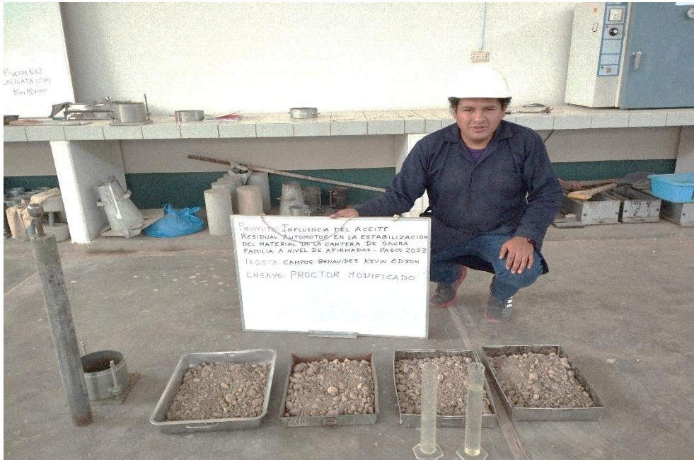
FOTOGRAFIA N°19: Materiales ensayo de Proctor modificado
