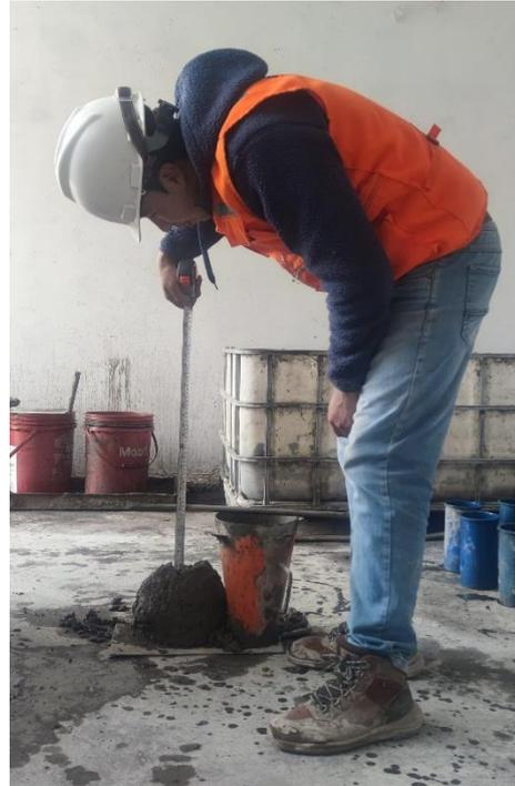
**IMAGEN 15.** *Medimos el asentamiento del concreto.*
