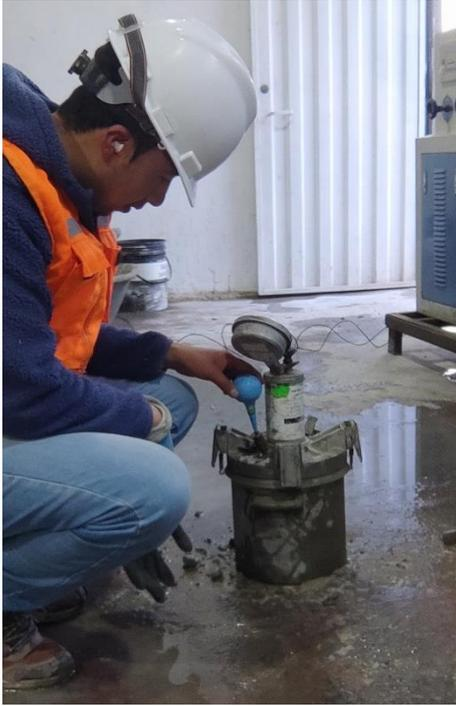
**IMAGEN 18.** Una vez terminado se procederá con el sellado y añadiremos agua a las válvulas.
