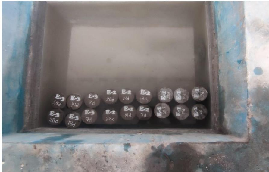
**IMAGEN 24.** *Colocado de las probetas una vez desmoldadas para el respectivo curado.*
