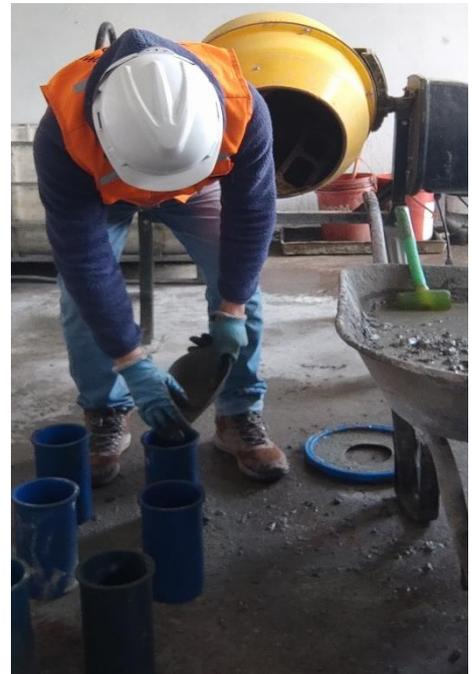
**IMAGEN 21.** Muestreo de probetas.
