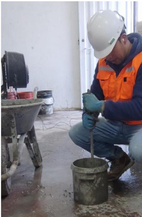
**IMAGEN 16.** *Ensayo de contenido de aire.*
