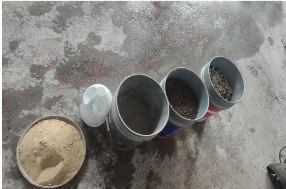
**IMAGEN 02.** Materiales a usar en sus respectivos recipientes de acuerdo a la dosificación para la elaboración de concreto  $f'c=210$  kg/cm<sup>2</sup>.
