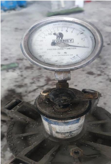
**IMAGEN 20.** Lectura del ensayo realizada el cual nos da como resultado 1% de contenido de aire.
