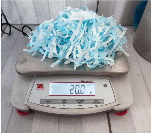
**IMAGEN 03.** *Pesaje de las fibras de mascarillas reciclada.*
