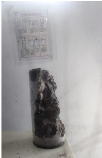
**IMAGEN 29.** *Espécimen ensayado con falla tipo B cono y separación.*
