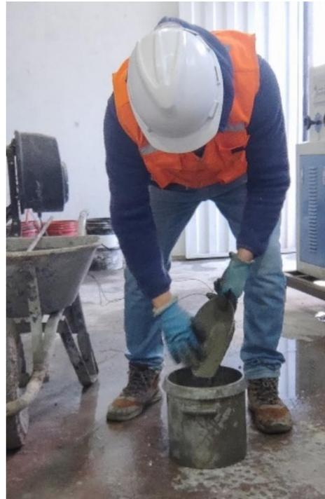
**IMAGEN 17.** *Se realizará el llenado de la olla Washington dando 25 golpes de forma espiral.*
