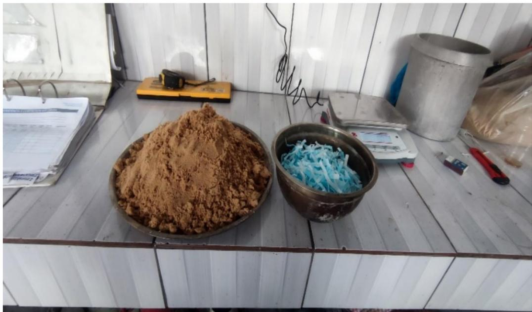
**IMAGEN 05.** *Arenisca cuarzosa para la elaboración de concreto  $f'c=210$  kg/cm<sup>2</sup>.*
