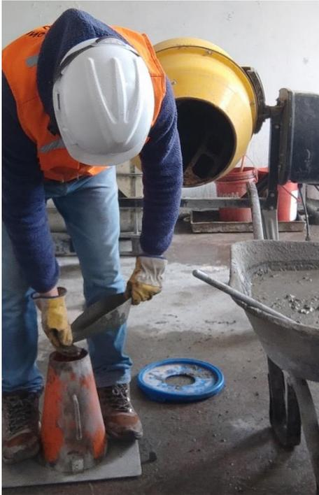
**IMAGEN 14.** *Se realizará el llenado del cono de Abrams dando 25 golpes de forma espiral.*
