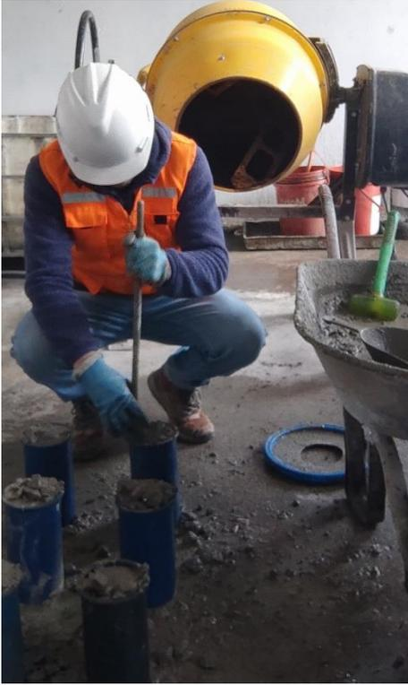
**IMAGEN 22.** *Varillado uniforme de forma espiral en los moldes de probetas.*
