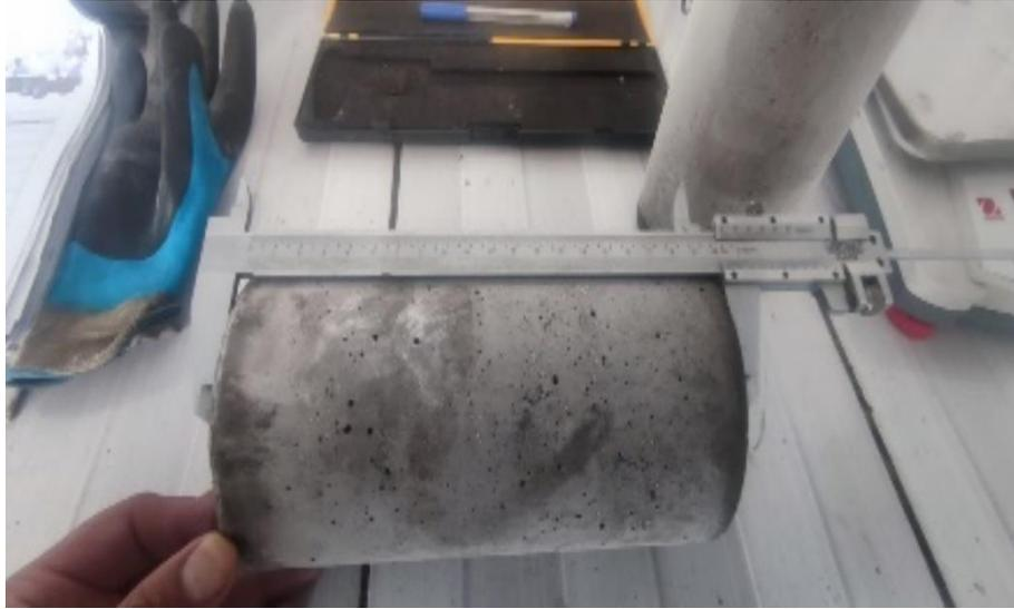
**IMAGEN 25.** *Toma de dimensiones de la probeta a ensayar.*
