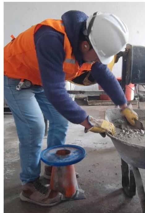
**IMAGEN 13.** Se realiza el ensayo de slump..
