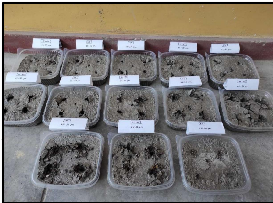
Figura 10: Probetas cuadradas después de las pruebas de penetrómetro
