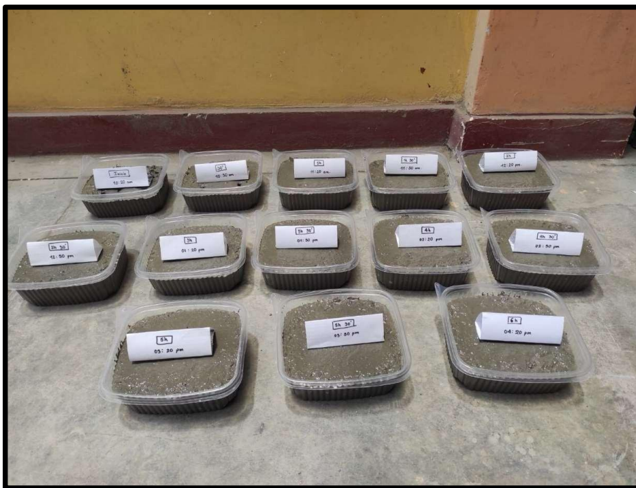
Figura 6: Probetas para la obtención de temperaturas y resistencias cada 30 min
