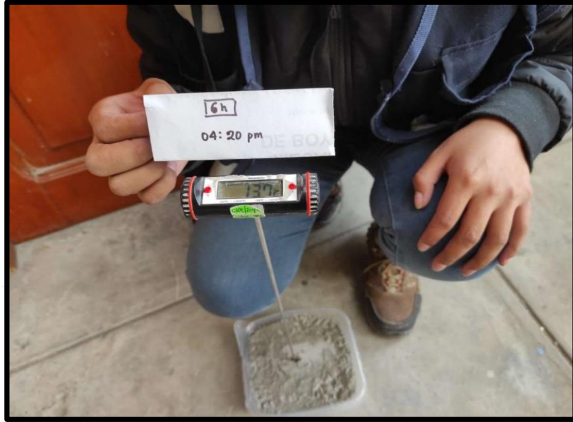
Figura 7: Obtención de la temperatura de la probeta final
