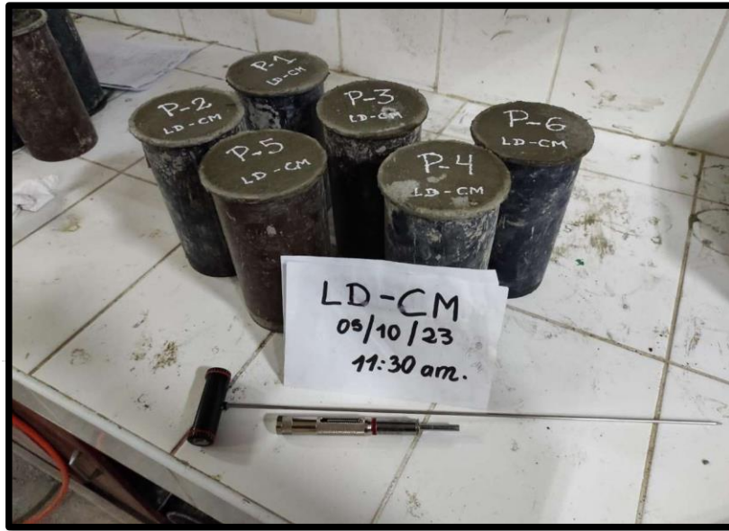
Figura 11: Probetas cilíndricas posteriormente para su ensayo a la compresión
