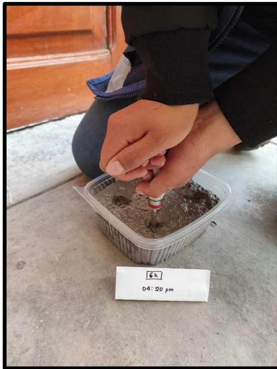
Figura 8: Obtención de la resistencia con la ayuda de un penetrómetro de la probeta final
