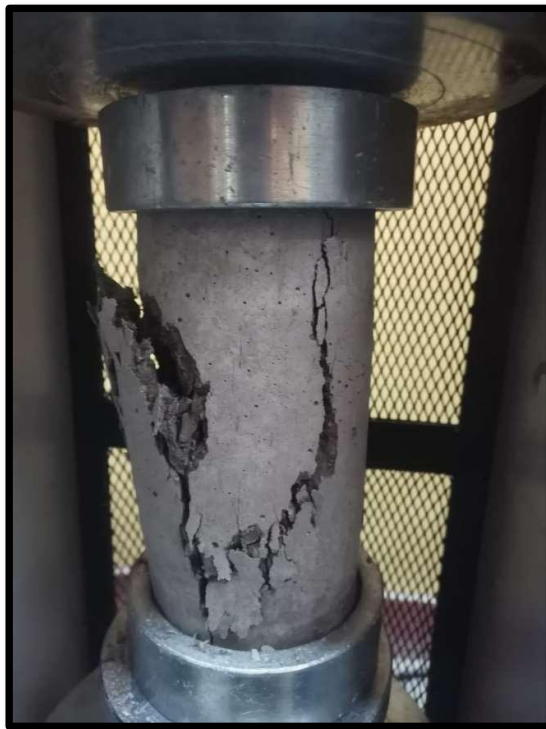
Figura 14: Probeta después del ensayo de compresión
