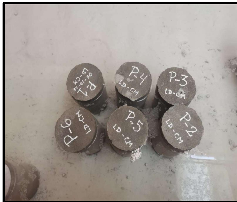
Figura 12: Curado de probetas cilíndricas
