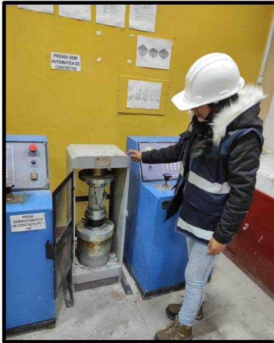
Figura 13: Ensayo de resistencia a la compresión
