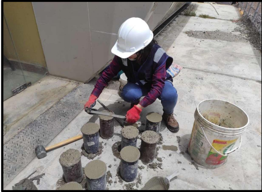
Figura 3: Enrasado del concreto a las probetas.
