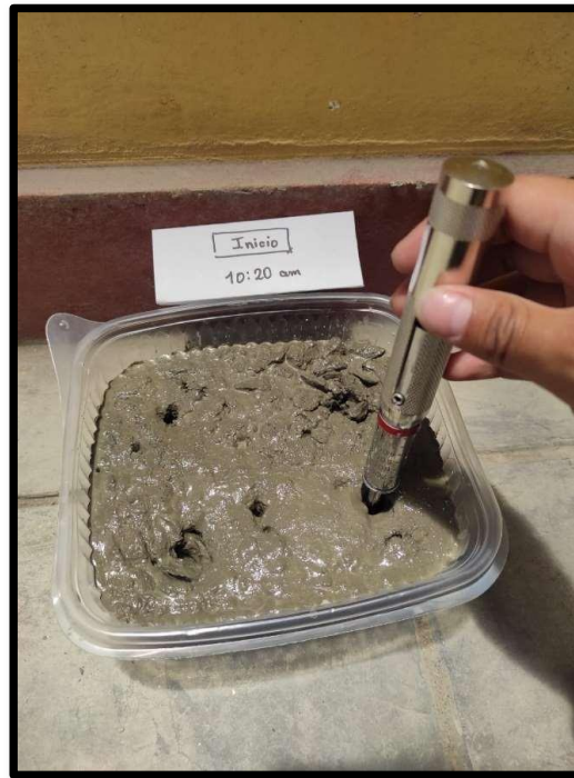
Figura 5: Obtención de la resistencia con la ayuda de un penetrómetro de la probeta inicial
