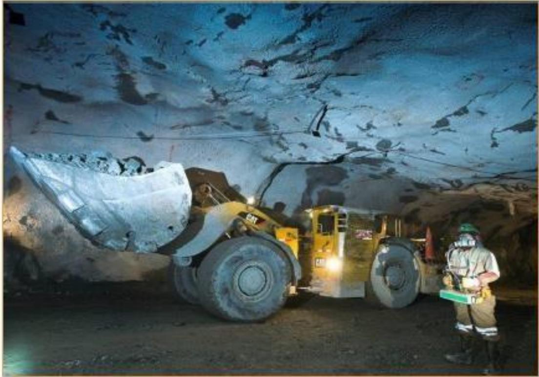
**Figura 23.** Limpieza de mineral del tajeo con equipo LHD a telemenado.
