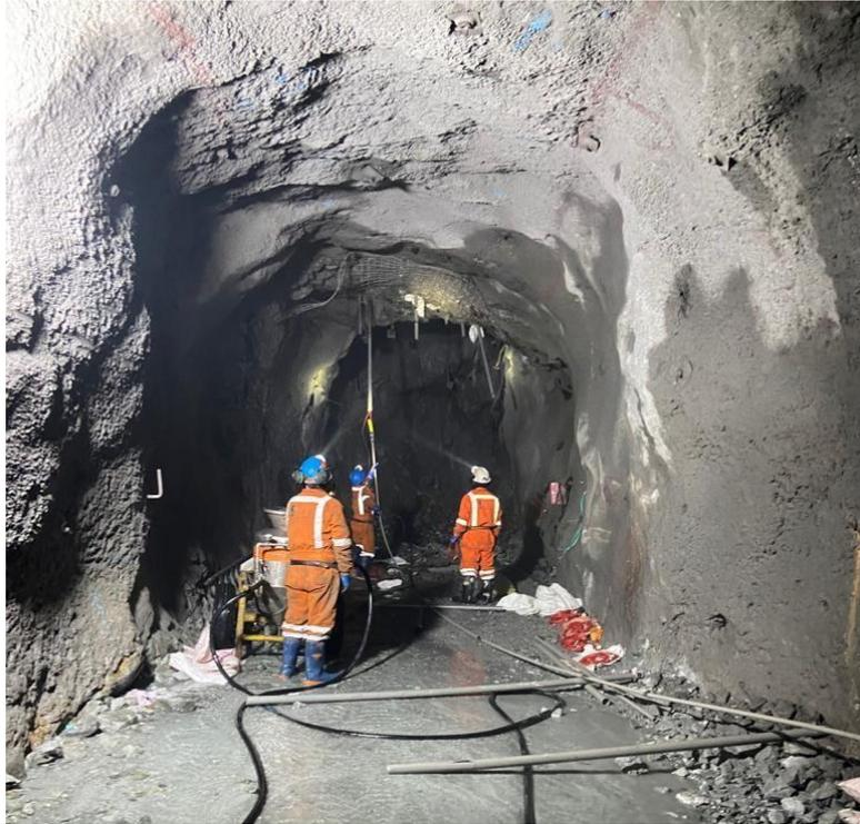
Figura 47. NV 4160 PISO N°04 Carguío de taladros de producción en Positivo bancada de 07mts en (+)
