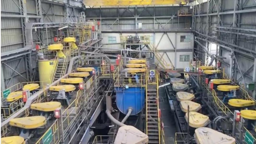
Figura 65. Área de Flotación de Zinc y Plomo de la Unidad Minera Santander.
