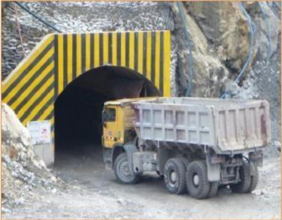
*Figura 25. Camiones de 14 m<sup>3</sup> para el transporte de mineral.*
