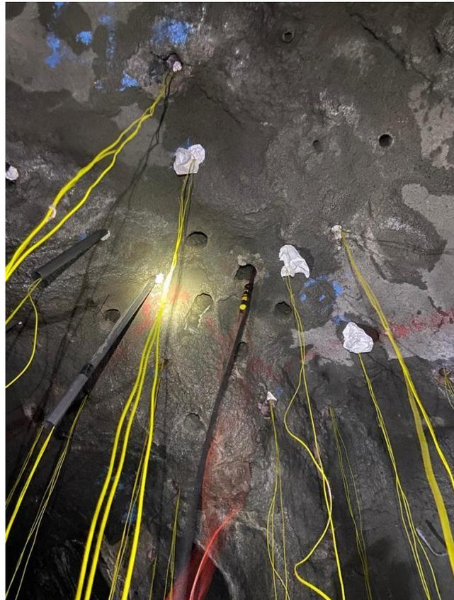
*Figura 52. NV 4090 2T 1N CARGUIO DE VCR EN POSITIVO 1ra ETAPA BANCADA DE 07Mts.*
