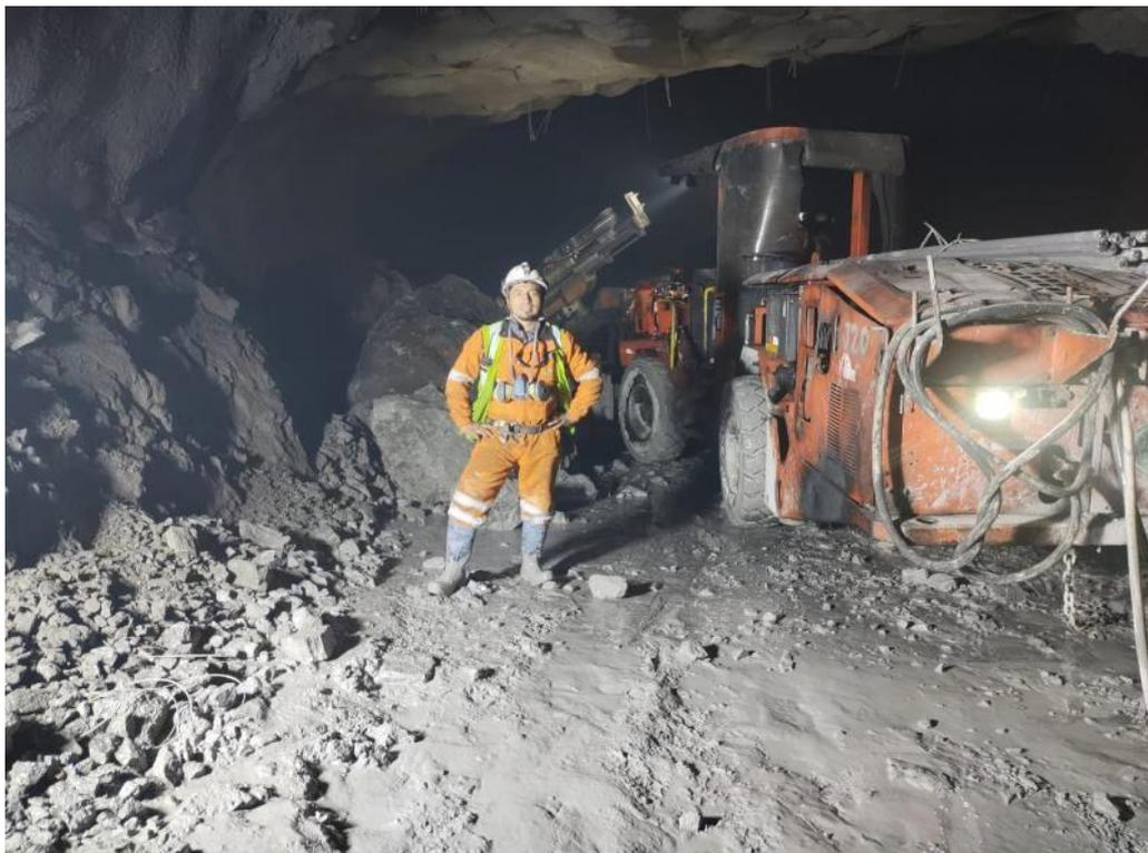
*Figura 58.* NV 4120 1N PISO N°03 RECUPERACION DE TAJO CACHORREO DE BANCOS CON JUMBO DD311 SANDVIK.
