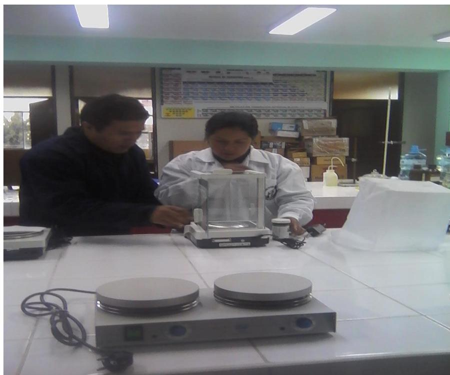
**Foto N° 06:** pesando muestra de sulfato de cobre, en la balanza analítica
