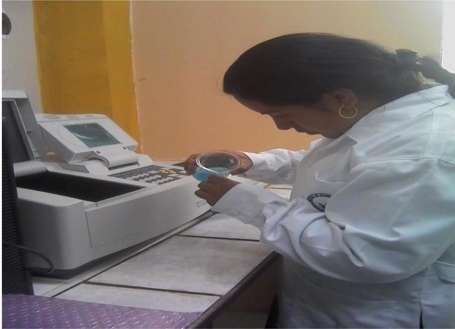
**Foto N° 07:** colocando solución sulfato de cobre, 4 ppm, en el equipo
