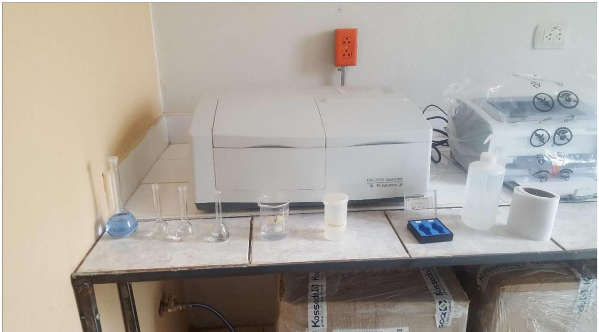
**Foto N° 04:** equipo espectrofotométrico UV-Visible
