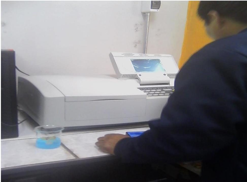
**Foto N° 09:** evaluando la longitud de onda máxima para la solución sulfato de cobre
