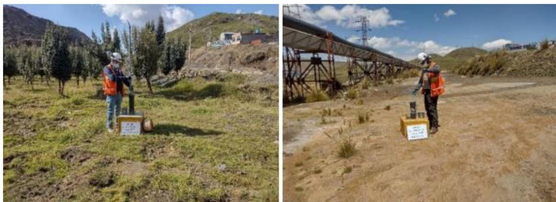
**Fotografía 2.** Prueba slug en Piezómetro AMP19-13 (izquierda) y prueba slug en Piezómetro AMP19-14 (derecha)
