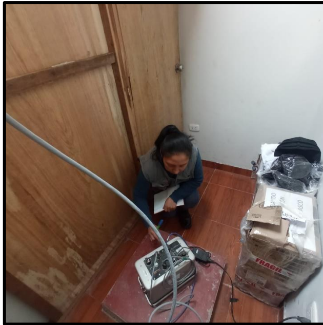
Fotografía N°01: Comprobación de sensibilidad del acelerógrafo.
