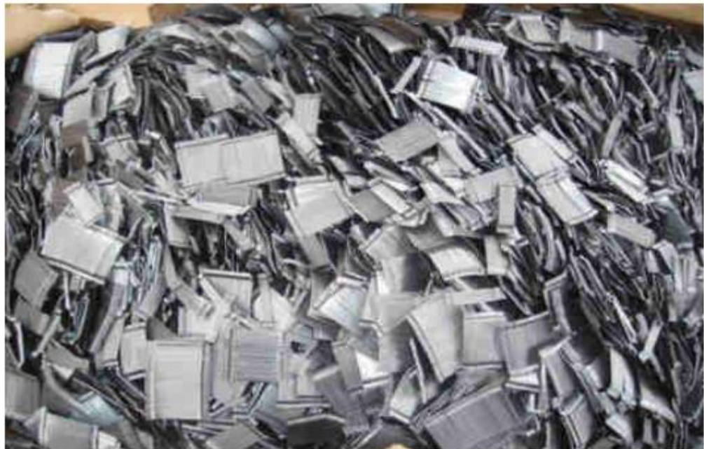
Figura 9. Fibra metálica para shotcrete vía húmeda
