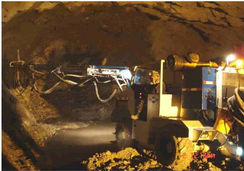
Figura 10. Equipo lanzador robotizado Alpha 20
